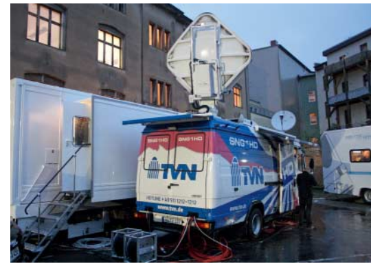
Fuhrpark: Während die 3D-Bearbeitung und Bildregie im unscheinbaren Ü-Wagen stattfand (links), schickte das SNG-Fahrzeug das fertige 3D-Signal an den Eutelsat-Satelliten. Hinten rechts ist der Audio-Ü-Wagen zu sehen.
