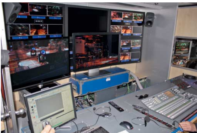
Chefbüro: Neben dem Bildmischer (rechts) waren zwei Polfilter-3D-Displays die wichtigsten Hilfsmittel im Ü-Wagen.
