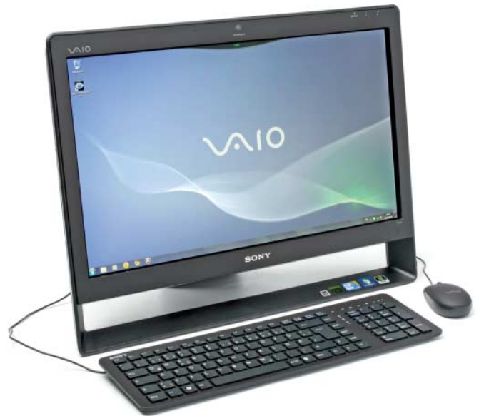
Sony stattet den Vaio VPC-J11M1E mit Mobilkomponenten aus. Damit ist er sparsamer, aber auch etwas langsamer als die anderen Rechner mit Desktop-PC-Prozessor.
