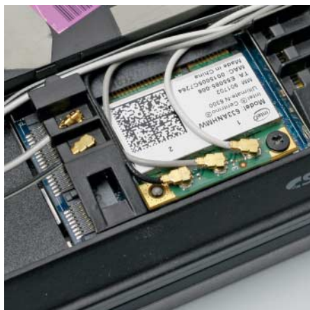
Wenn drei Antennenkabelchen im Einbaufach des WLAN-Adapters ankommen und das BIOS mitspielt, lässt sich ein schnellerer WLAN-Adapter einbauen.
