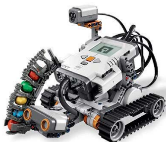
MINDdroid steuert Lego-Roboter der Mindstorms-NXT-Serie via Bluetooth.
