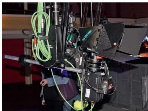
Um die Ecke geguckt: In Halle kamen sogenannte Stereo-Rigs zum Einsatz, in denen jeweils zwei Kameras im 90-Grad-Winkel stecken. Dank halbdurchlässiger Spiegel produzieren die Rigs Bilder, als wären die Kameras nebeneinander montiert.
