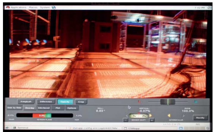
Geradebügler: Die vom Fraunhofer HHI entwickelte STAN-Software rechnet Höhenversatz und andere Verzerrungen aus den Stereobildern.
