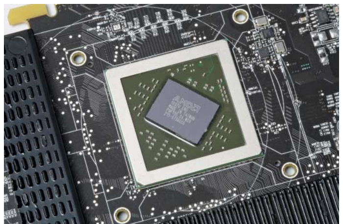
Der Barts-Grafikchip ist 255 mm 2 groß und beherbergt je nach Variante bis zu 1120 Shader-Rechenkerns.
