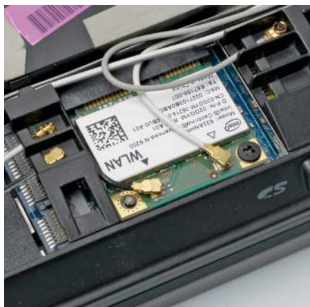
Wenn drei Antennenkabelchen im Einbaufach des WLAN-Adapters ankommen und das BIOS mitspielt, lässt sich ein schnellerer WLAN-Adapter einbauen.
