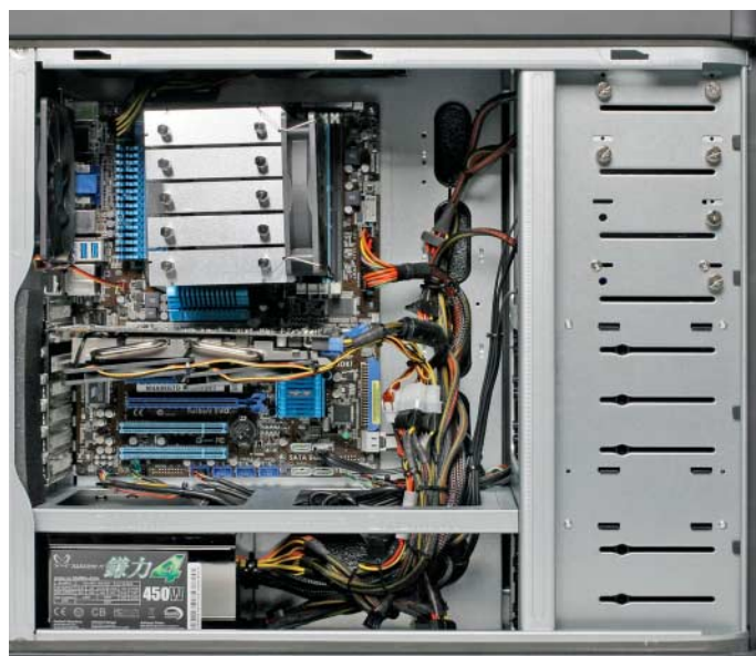
Die Strom- und Datenleitungen im AMD Schwartz PC hat der Hersteller mit Kabelbindern fixiert.
