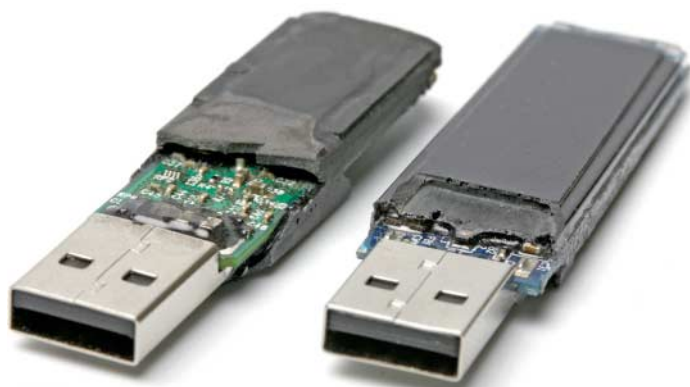
Auch nach dem gewaltsamen Öffnen der vergossenen Gehäuse stecken die Platinen des DT5000 von Kingston und des Ironkey noch in einem dicken Panzer aus widerstandsfähigem Epoxydharz. Das macht einen Hardware-Angriff nicht unmöglich, aber sehr aufwendig und teuer.
