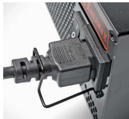
Der Haltebügel beim Modu87+ war für den mitgelieferten Stecker etwas zu groß, sodass er trotz Halterung bis zum Stromausfall herausrutschen kann.
