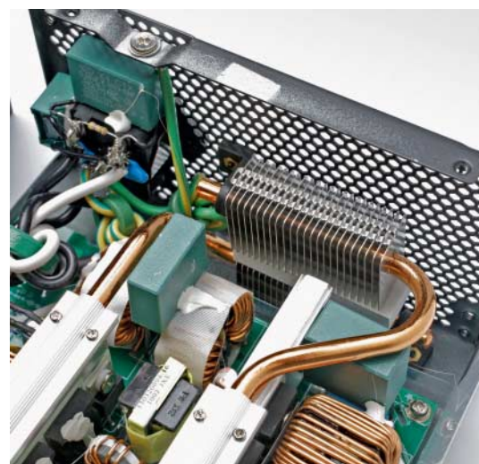
Tagan verbessert beim PipeRock III die Kühlung mit Heatpipes und einem Radiator vorm Luftauslass. Dennoch war das Gerät bei Volllast nicht besonders leise.
