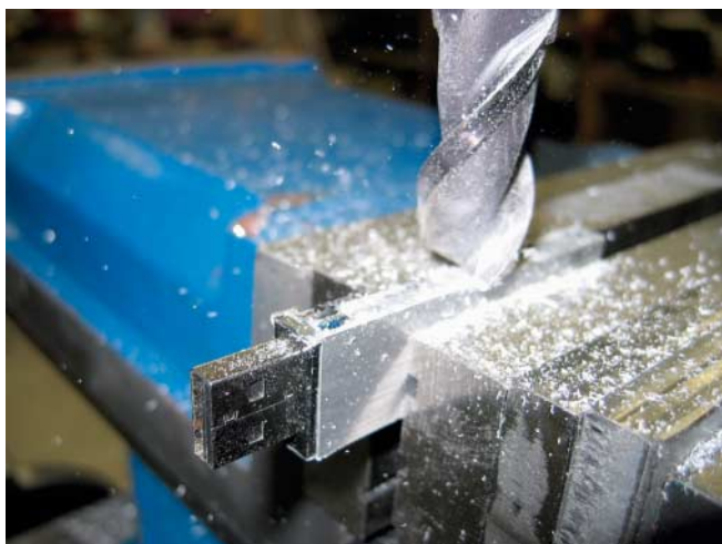
Nicht gerade spurlos: Vollvergossenen Metallgehäusen wie dem des Ironkey muss man mit schwerem Werkzeug oder extrem viel Geduld zuleibe rücken.
