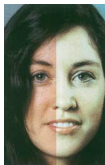
Hauttöne werden bei Dell an der Sonne unansehnlich, das Premium-Papier vergilbt.
