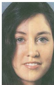
Die Canon-Tinten verblassen unter UV-Einfluss, auf Platinum-Papier (rechts) weniger.
