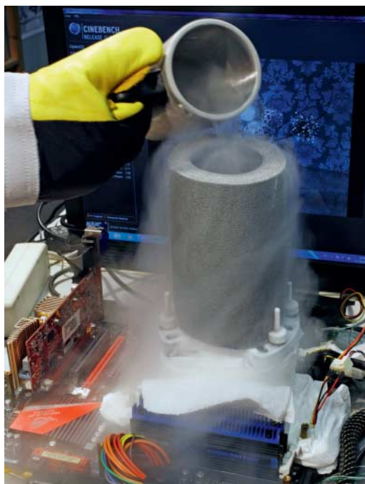
Da der Stickstoff ständig wegekocht, muss man im Abstand weniger Minuten neues Kühlmittel nachfüllen.
