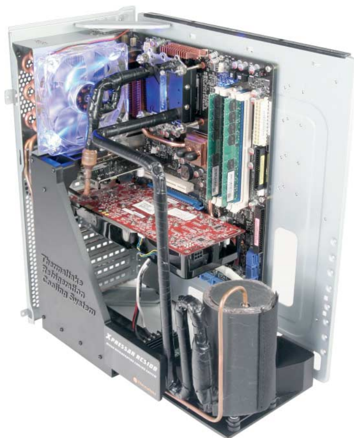
Die Kompressorkühlung RCS-100 stammt von Thermaltake und wird bereits fertig eingebaut in einem PC-Gehäuse ausgeliefert. Im Vordergrund befindet sich der Kompressor, den Wärmetauscher positioniert der Hersteller an der Rückseite des Gehäuses.
