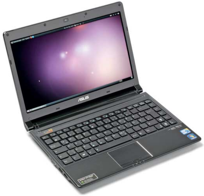
Durch Nvidias Optimus ist das von Ixsoft mit Ubuntu 10.04 ausgestattete Asus PL30J denkbar ungeeignet für den Linux-Einsatz.
