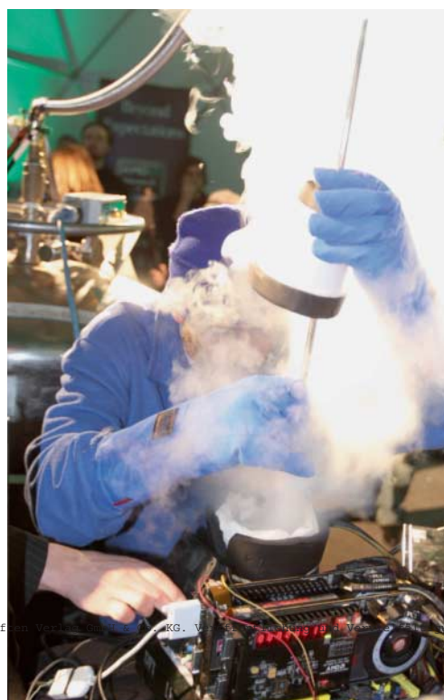
Bei einem Rekordversuch von AMD wurde das flüssige Helium direkt vom Vorratsbehälter in den CPU-Kühler geleitet.
