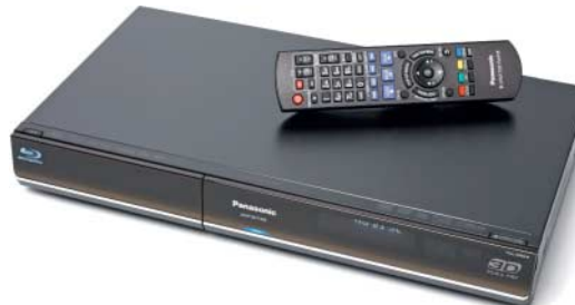
Panasonic DMP-BDT300: entweder niedriger Standby-Stromverbrauch oder lange Bootzeit; recht lahm bei BD-Java; keine NTFS-Unterstützung; zu wenig Strom für 2,5-Zoll-Testplatte an der USB-Buchse; als DLNA-Client beschränkt
