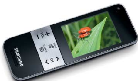
Samsungs TV-Fernbedienung hat ein 3"-Touch-Display und ist dank eingebautem Tuner auch Mini-Fernseher.
