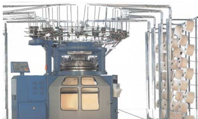
Scheduling-Fehler sichtbar gemacht: Kommt der Prozess zur Steuerung der Nadelbewegungen dieser Strickmaschine aus dem Takt, äußert sich das direkt in einem mangelhaften Textilstück.
