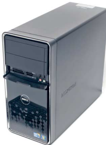
Beim Zufahren verhakt sich das optische Laufwerk des Inspiron 580 an der schwarzen Frontklappe.
