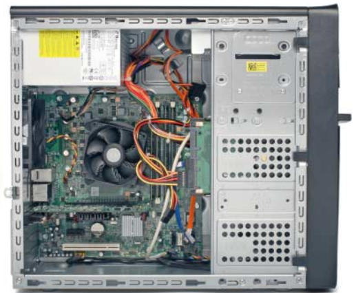
Beim Zufahren verhakt sich das optische Laufwerk des Inspiron 580 an der schwarzen Frontklappe.
