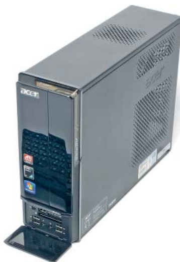
Der kleinste Rechner im Test hat die schnellste Grafikkarte: Im Aspire X1301 steckt eine Radeon HD 5570.
