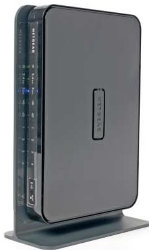
Der Netgear WNDR3700 ist einer von zahlreichen Routern, auf denen OpenWRT läuft.
