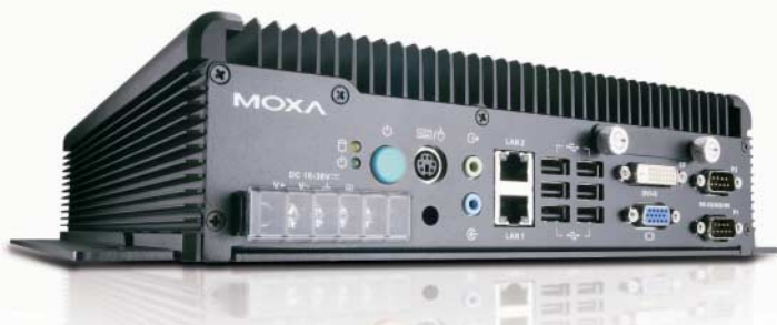
Ein robustes Gehäuse mit Wandhalterung und passiver Kühlung qualifizieren den MC-4510-C23 von Moxa für den Einsatz als Schiffcomputer.
