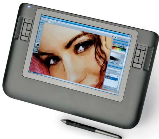
Das Cintiq 12WX ist vor allem für mobile Anwender konzipiert. Ein Teil der Elektronik ist in eine Konverterbox ausgelagert (siehe Bild auf S. 139).
