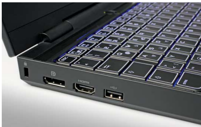
Der Rumpf ist verhältnismäßig dick; externe Monitore finden per HDMI und DisplayPort Anschluss.
