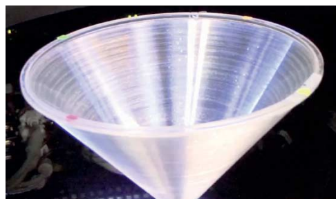
Im Kreis angeordnete Picobeamer projizieren auf einen zylinderförmigen Spiegel, der das Licht in Richtung Glasoberfläche lenkt.
