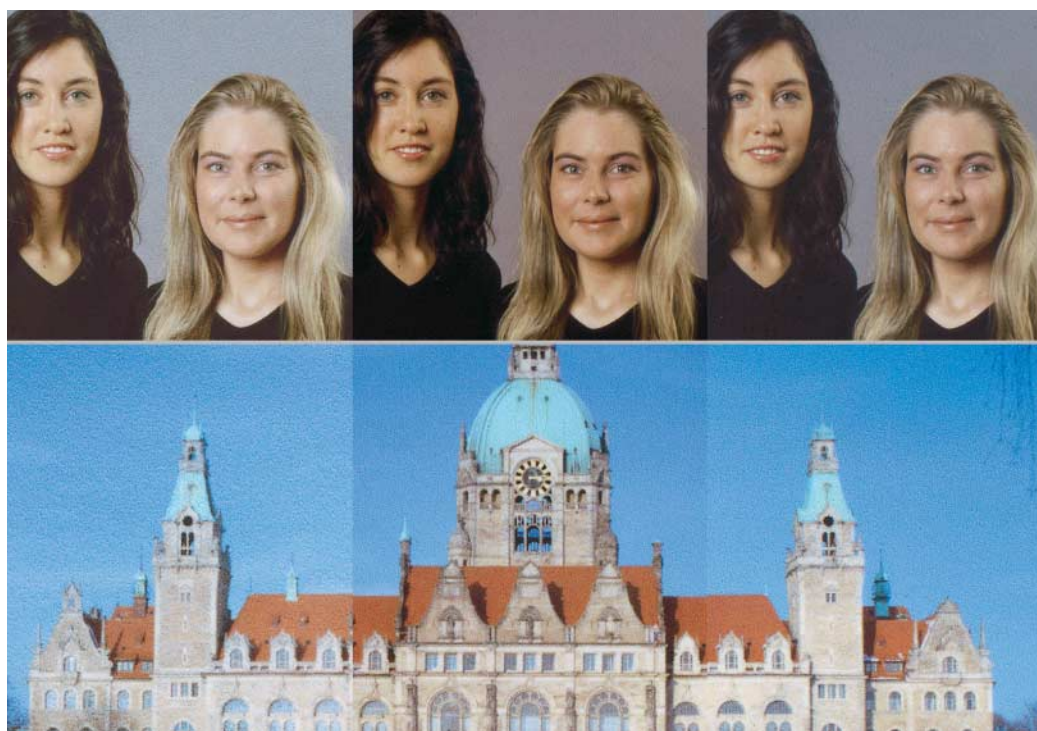
Mit der Epson-Tinte (Mitte) wirken die Farben etwas flau, mit der von CartridgeWorld (links) deutlich zu blass. Die Tinte von iColor (rechts) erzeugt dagegen natürliche, kräftige Farben auf dem Foto.
