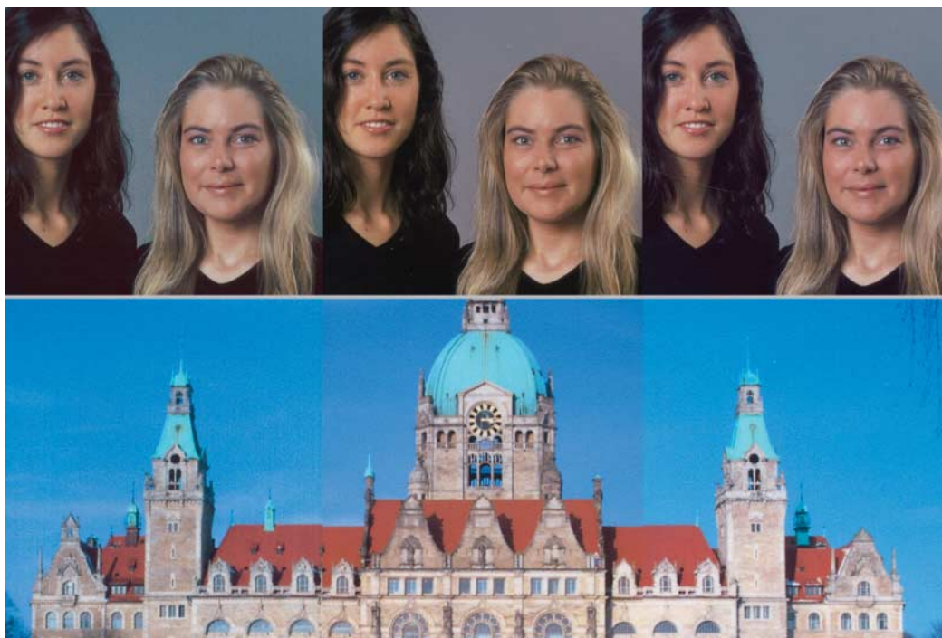
Canon-Drucker geben Hautfarben mit einem leichten Rotstich wieder (Mitte). Mit Alternativ- Patronen von Peach (rechts) sehen die Hautpartien natürlicher aus. Die Druckergebnisse mit Tinte von CartridgeWorld fällt zu bläulich aus.
