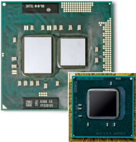
Bei Intels Core-i-Doppelkernen steckt eine GPU im gleichen Chipgehäuse, beim Sparmeister Atom (rechts) ist sie auf dem Chip integriert.
