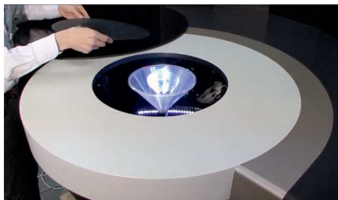
Im Kreis angeordnete Picobeamer projizieren auf einen zylinderförmigen Spiegel, der das Licht in Richtung Glasoberfläche lenkt.
