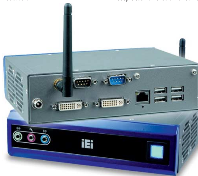
Im Inneren des kompakten, aber nicht lüfterlosen Rechners ECN-581A steckt aktuelle Notebook-Technik von Intel.
