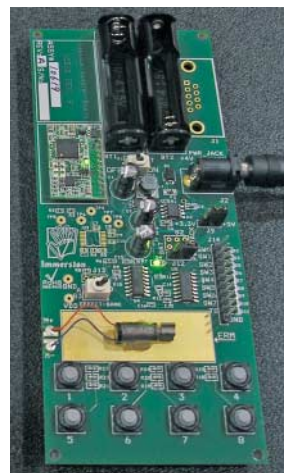
Die kleine Exzentrerscheibe (im gelben Feld) schlägt bei Berührungen gegen das Display und bringt es in Schwingung.
