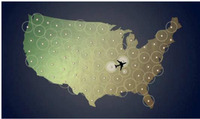
Aircells Gogo Inflight Internet nutzt 92 modifizierte Mobilfunk-Basisstationen, um Flugzeuge über den USA vom Boden aus zu versorgen.
