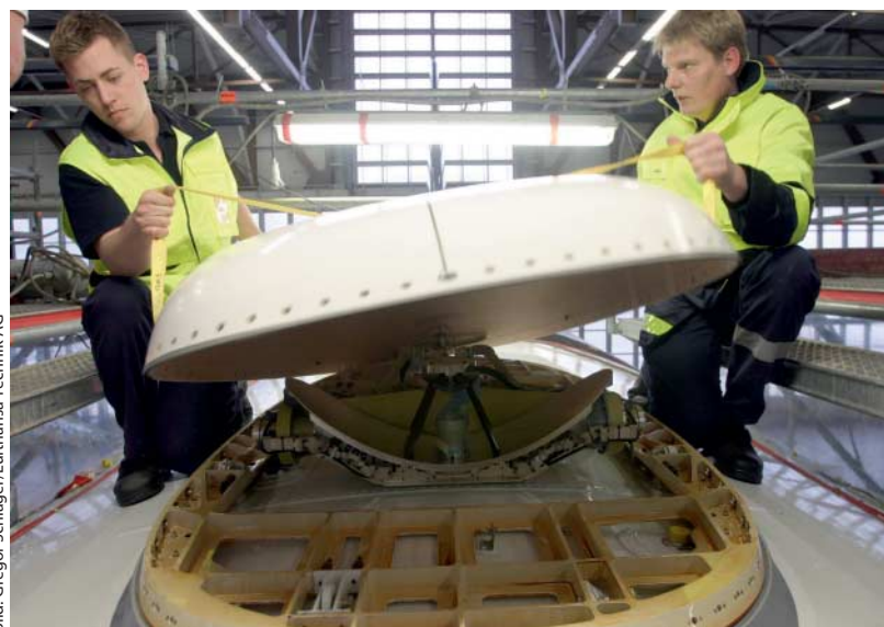
Die Connexion-Satellitenantenne ist relativ groß und erhöht mit ihrer Abdeckung (Radom) den Luftwiderstand vor allem kleinerer Flugzeuge deutlich.
