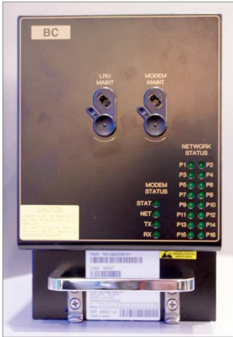
Herzstück von Panasonic GCS ist ein etwa schuhkarton-großer Controller, der die Verbindungen zwischen Satellit und den Onboard-Access-Points herstellt.
