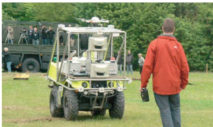
Der Roboter „Amor“ von der Universität Siegen hat einen Quadrocopter an Bord, konnte ihn bei der diesjährigen Elrob aber noch nicht fliegen lassen.
