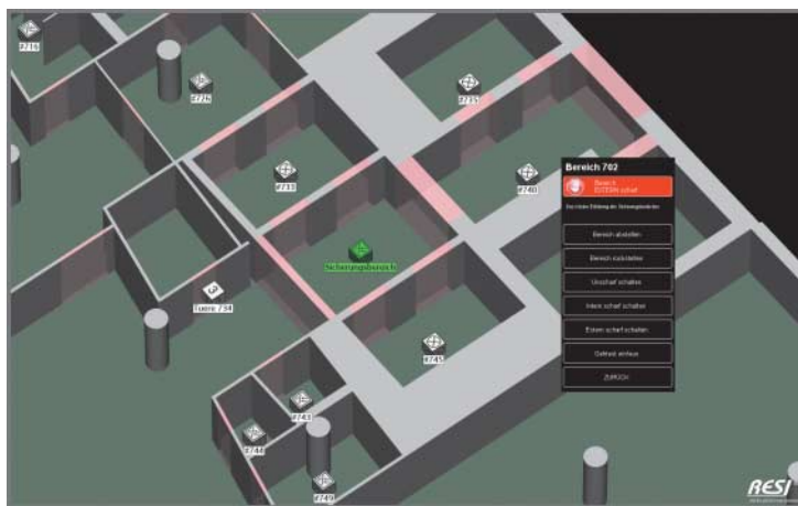
RESI-SCADA-3D ermöglicht die Steuerung und Überwachung der Haustechnik auch von großen Gebäuden.
