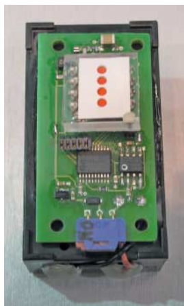
Die Öltröpfchen-Anzeige von ADT verharrt bei Wegfall der Versorgungsspannung in ihrer letzten Position.
