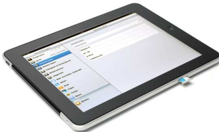
Optisch erkennt man das iPad 3G am schwarzen Plastikstreifen am Rand. Dahinter sitzen die UMTS-Antennen. Die Schublade für die Micro-SIM öffnet man per Büroklammer.
