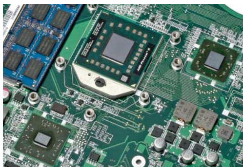
AMDs Plattformen bestehen aus CPU (Mitte), Northbridge mit integrierter Grafikeinheit (rechts) und Southbridge (links unten).
