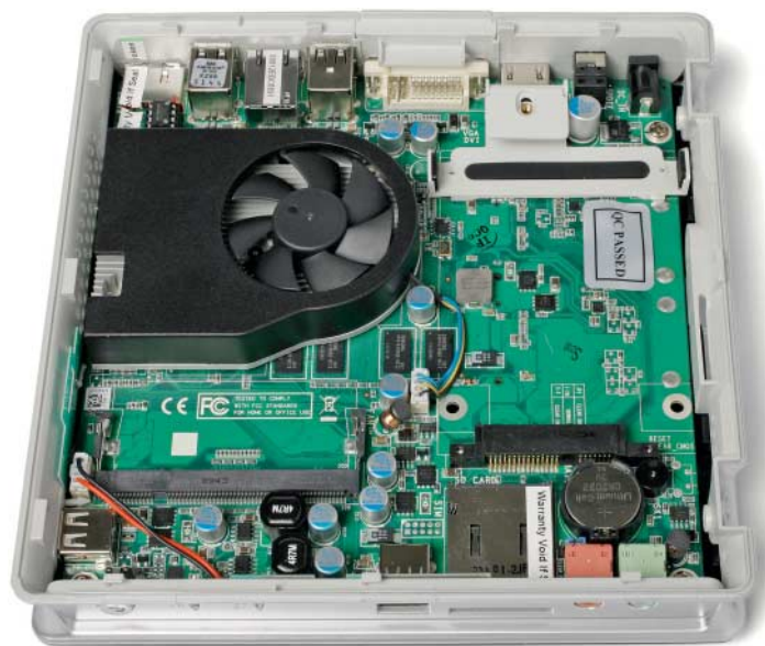
Die RAM-Chips des Grafikspeichers lugen unter dem Kühlkörper für Chipsatz, GPU und Prozessor hervor.
