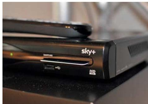
Skys erster HDTV-Recorder trägt den Namen „Sky+“, hat eine 320-GB-Byte-Festplatte und kommt aus dem Hause Pace.
