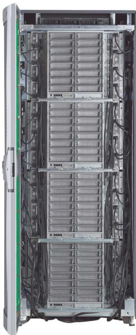
SGI Altix ICE 8400: modularer HPC-Cluster mit QDR-IB-Interconnect und bis zu 131 072 Prozessoren
