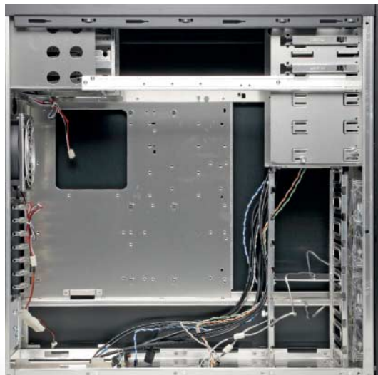
Bis zu zehn Festplatten und fünf optische Laufwerke lassen sich in den Big-Tower Lian Li PC-A70F einbauen.
