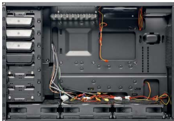
Silverstone dreht im Raven RV02 das übliche Tower-Konzept um 90 Grad. Unter die Abdeckung auf der Oberseite passen aber beispielsweise keine DVI-HDMI-Adapter.
