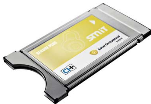
Das CI-Plus-CAM von Kabel Deutschland stammt vom chinesischen Hersteller SMIT, als Verschlüsselungssystem kommt Videoguard von NDS zum Einsatz.
