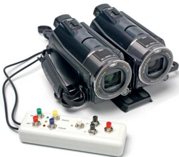
Unser ambitionierter Bauvorschlag: Zwei HDR-CX550-Camcorder von Sony, die per LANC-Controller synchronisiert werden.
