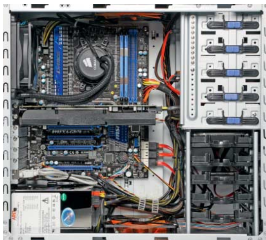
Arlt Gamer 7-11 Reloaded: sechs CPU-Kerne, fette Grafikkarte plus Edelkomponenten wie Wasserkühler und SSD
