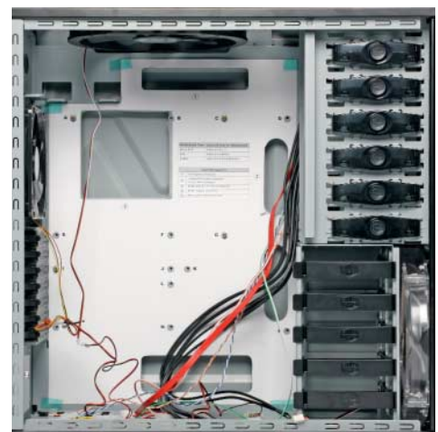
Um den großen Lüfter im Gehäusedach unterzubringen, ist das Cooler Master HAF 932 mit 24 cm deutlich breiter als die restlichen Tower.
