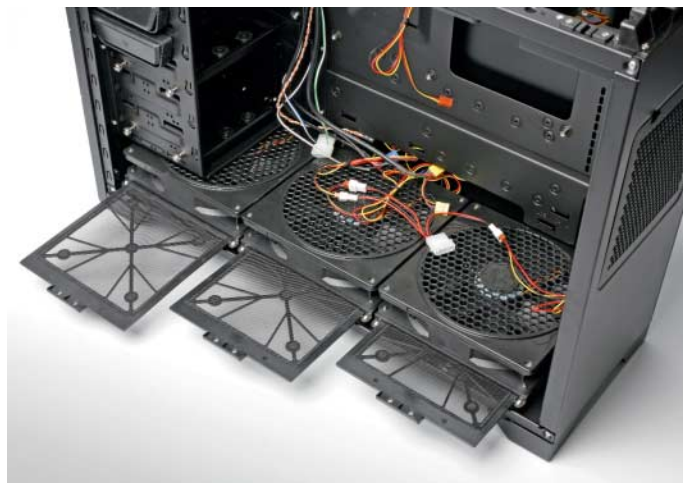
Silverstone bannt die Fusselgefahr beim Raven RV02 mit drei leicht zu reinigenden Staubfiltern.
