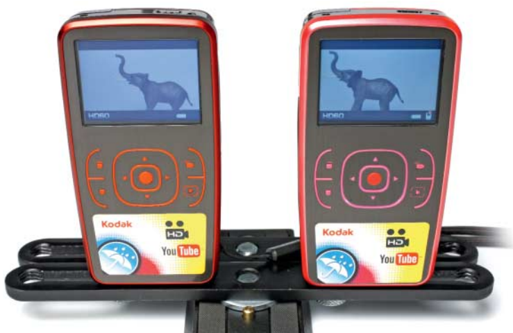
Unser preisgünstiger Bauvorschlag: Zwei Zx1-Kameras von Kodak – die Aufnahme wird per Infrarot-Fernbedienung gestartet.
