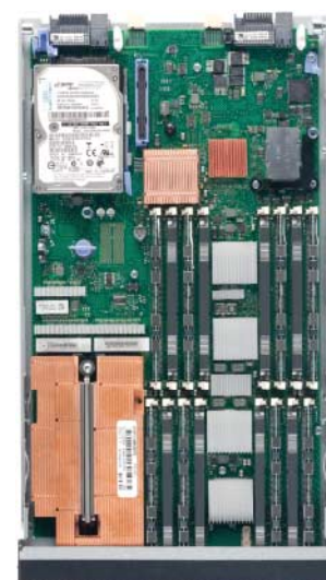
IBM packt bis zu 16 Power7-Kerne ins Blade-Format.
