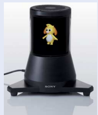
Dieses volumetrische Display von Sony nutzt Leuchtdioden, um ein räumliches Bild aufzubauen.
