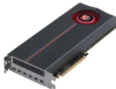
Um die sechs Monitorausgänge auf der Slotblende unterzubringen, verwendet AMD Mini-DisplayPort-Buchsen.
