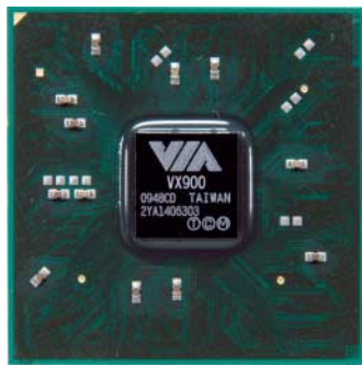
Der Chip des VX900 befindet sich auf einem 31 mm × 31 mm großen Träger.
