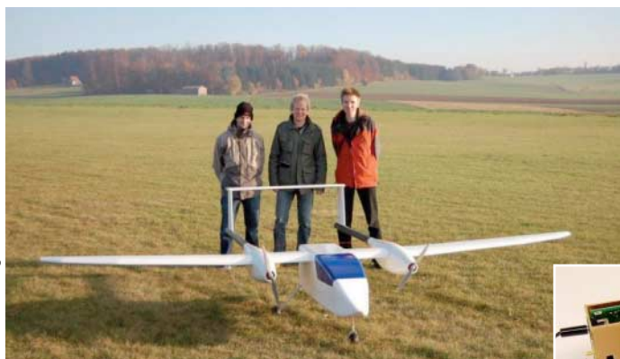
Der Autopilot Tiny 2.11 der Open-Source-Initiative Paparazzi kommt auch beim „Adler“ der Universität Stuttgart zum Einsatz. Der zweimotorige Starrflügler erforscht das Zielgebiet mit (Wärmebild-)Kameras und Spektrometer (unten im Bild).
