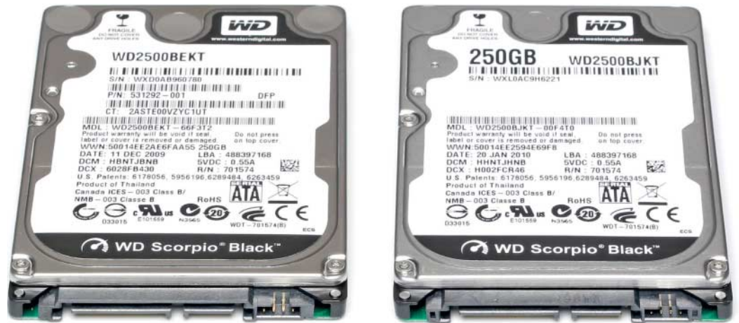
Die leistungsmäßig ebenbürtigen Notebookplatten WD2500BEKT und WD2500BJKT unterscheiden sich lediglich durch den eingebauten Freifallsensor, für den WD bei den BJKT-Modellen einen Aufpreis verlangt.
