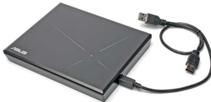
Slim-Line-Laufwerke wie das Asus SBC-06D1S-U arbeiten mit reduzierter Geschwindigkeit, was der Brennqualität und den Laufgeräuschen zugute kommt.
