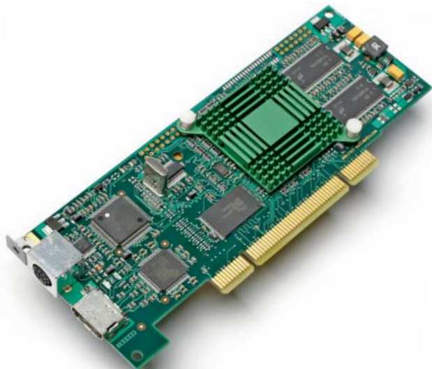
Die Reel Multimedia eHD ist ein reiner HD-Decoder und mit 140 Euro vergleichsweise billig. Bei den Anschlüssen und der Kabelpeitsche der eHD vermissen wir einen Tonausgang.
