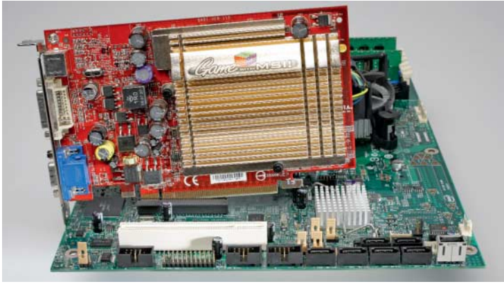
Auf manchen Mainboards passen PCIe-x16-Grafikkarten nicht in die x8-Steckplätze.
