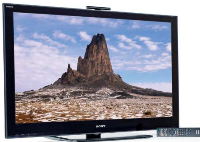
Der Sony KDL-46HX905 (Vorseriengerät) beweist, was eine flächige LED-Hintergrundbeleuchtung leisten kann: satte Kontraste, schöne Farben, gleichmäßige Ausleuchtung.
