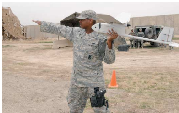
Wie bei den Modellbauern: Eine RQ-11 Raven wird per Muskelkraft in die Luft befördert. Das gerade mal zwei Kilogramm schwere Fluggerät erfüllt hauptsächlich Observationsaufgaben.
