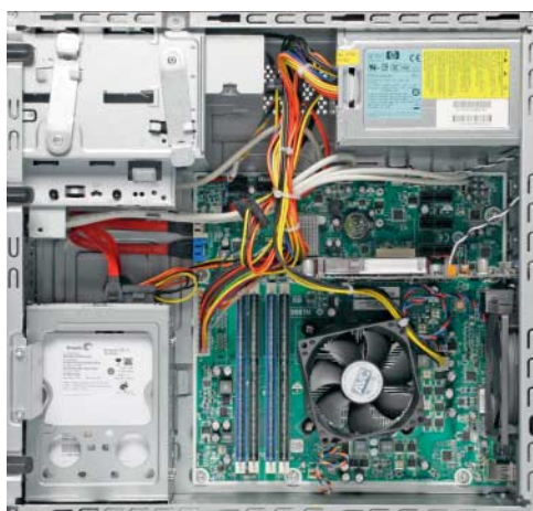
Hewlett-Packard verwendet für den Pavilion p6228de ein BTX-ähnliches Konzept, bei dem das Mainboard um 180 Grad gedreht im Gehäuse sitzt, sodass sich die Steckkarten über dem Prozessor befinden.
