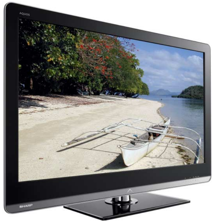
Sharps Quattron-Modelle: vier Grundfarben, 100-Hz-Technik und Triple-Tuner für HD
