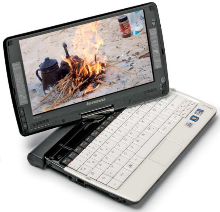
Der Deckel von Lenovos Ideapad S10-3t lässt sich drehen; der kapazitive Touchscreen versteht Mehrfingergersten.
