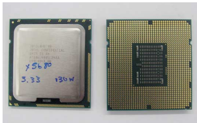
Hier noch vom Intel-Entwickler „handsigniert“, der Xeon X5680 (Westmere-EP) mit 3,33 GHz
