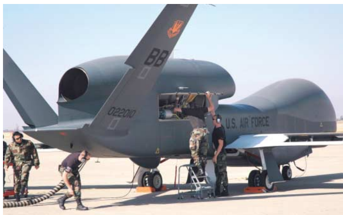
Mit einem Startgewicht von über 14 Tonnen das derzeit größte UAV: der Global Hawk, hier bei der Wartung durch Air-Force-Soldaten
