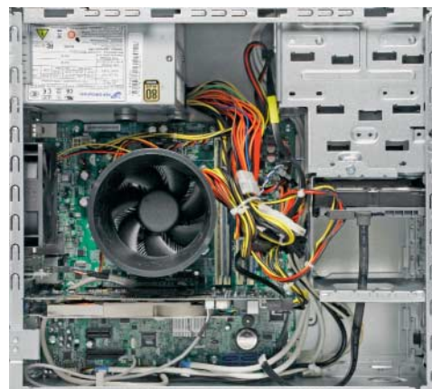
Der Core-i5-Prozessor im Acer Aspire M5810 taktet per Turbo Boost nur eine statt vier 133-MHz-Stufen hoch.
