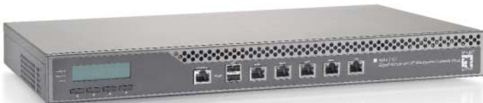
Die Gateways aus der LevelOne-Serie AMG-21xx steuern den WLAN-Zugriff, priorisieren den Netzwerkverkehr und helfen bei der Einrichtung und Verwaltung von öffentlichen Hotspots.
