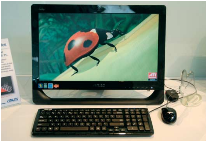
Die All-in-One-PCs Asus EeeTop ET2010AG und ET2010PNT funktionieren dank HDMI-Eingang auch als Monitore.
