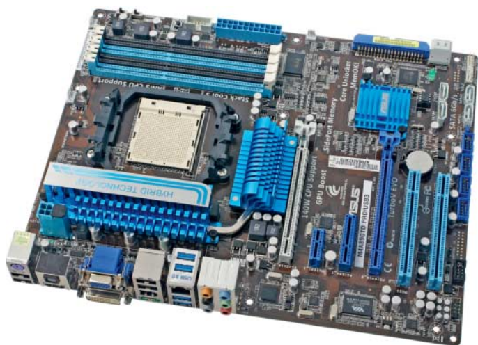
Asus M4A89GTD Pro: Der AMD 890GX bringt SATA 6G und dank vollwertigem PCIe 2.0 auch hohe USB-3.0-Performance.
