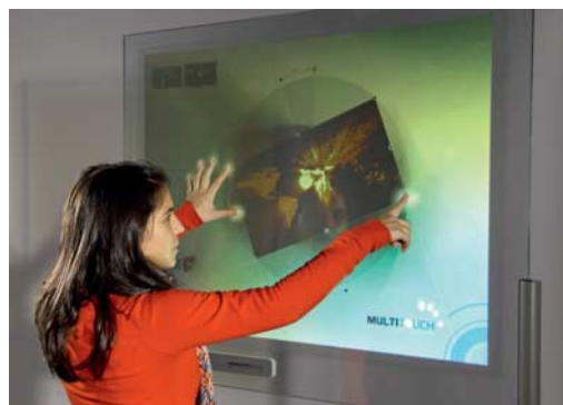
Die flexiblen Folien von Displax verwandeln nicht leitende Flächen in berührungsempfindliche Displays.
