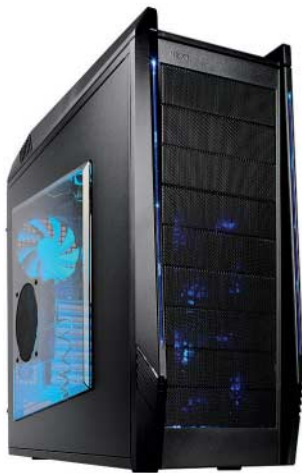
Hinter den luftdurchlässigen Laufwerksblenden des NZXT Tempest Evo sitzen Staubfilter.
