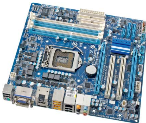
Gigabyte H55M-UD2H: Über den DisplayPort gelingt die Ansteuerung von Monitoren mit einer Auflösung von 2560 × 1600.
