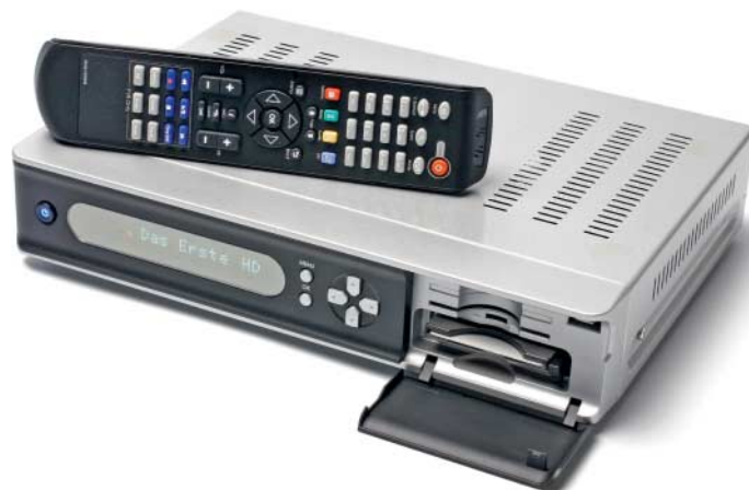
MatriXX Systems' NanoXX 9800 HD ist äußerlich vom NanoXX 9500 HD lediglich durch seine vier Antennenanschlüsse an der Rückseite zu unterscheiden.
