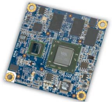
CPU, Chipsatz und Speicher bringt VIA auf dem Mobile-ITX-Board EPIA T700 unter. Für Standardbuchsen bleibt jedoch kein Platz.
