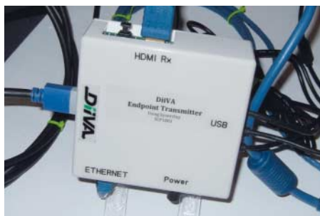
DiiVA-Bridges – hier ein Prototyp von Synerchip – sollen zwischen HDMI-, IP-, USB und SPDIF-Protokollen vermitteln.
