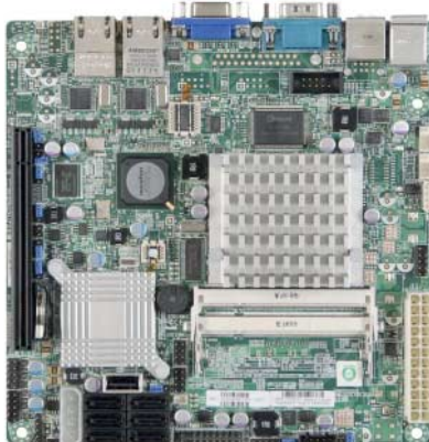
Mini-ITX-Serverboard mit 6 x SATA, 2 x LAN und Fernwartung: Supermicro X7SPA-HF
