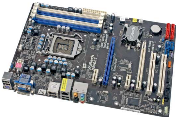
Asrock H55DE3: Über eSATAp-Buchsen übertragen passende Speichermedien schnell Daten und versorgen sich mit Spannung.
