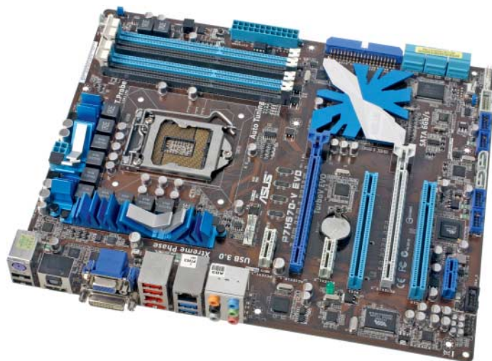
Asus P7H57D-V Evo: Teures Board mit Intels H57, das mit RAID-, SATA-6G- und USB-3.0-Unterstützung aufwartet
