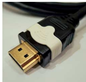
HDMI-Stecker mit Verriegelung von Polar Creative: Schiebt man den weißen Ring nach vorne, fahren aus den Löchern kleine Stifte heraus.
