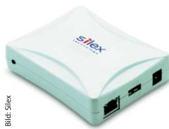
Der Deviceserver KD-2000 von Silex bringt ältere Kodak-Multifunktionsgeräte ins LAN.
