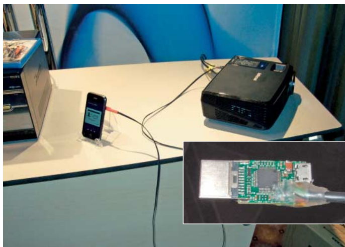
Ein von Silicon Image präsentiertes iPhone mit MHL-Modifikation gab in der Demonstration Power-Point-Präsentationen über eine Micro-USB-Buchse an einen Projektor aus. Für aktuelle HDMI-Fernseher und Projektoren ohne MHL-Unterstützung soll es ein Adapterkabel geben (rechts ein Prototyp).
