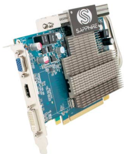
Sapphire bietet mit der Radeon HD 4670 Ultimate eine lüfter- und damit geräuschlose Mittelklasse-Grafikkarte an.
