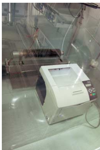
Künftig auch mit Feinstaubmessung: Prüfkammeruntersuchung für den Blauen Engel an einem Laserdrucker
