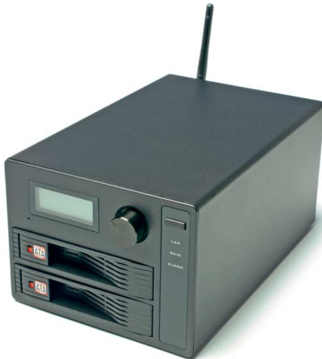
Die Mighty Box von One Technologies funkt Daten auch per WLAN – allerdings nur auf sehr kurze Distanz.
