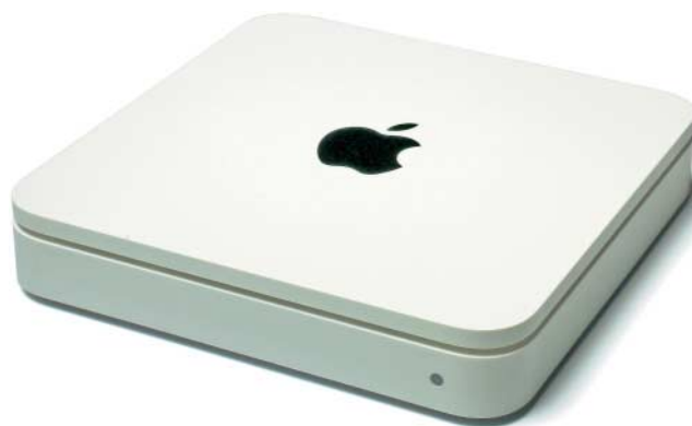
Unter der Bezeichnung Time Capsule verkauft Apple einen Breitbandrouter mit integrierter Festplatte und einfachen NAS-Funktionen.
