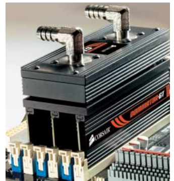
Manche Hersteller stellen die Energieeffizienz ihrer Produkte heraus, andere die Über-taktungsfähigkeit: wasser-gekühltes RAM von Corsair.
