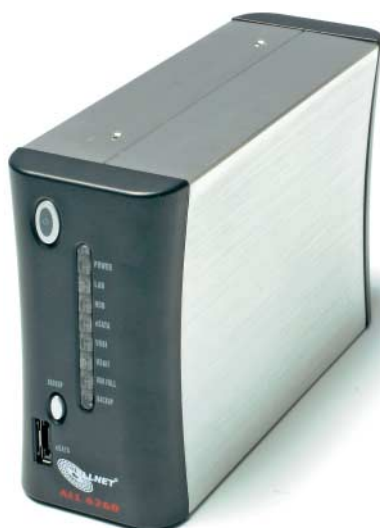
Das NAS-Leergehäuse ALL6260 des Distributors Allnet erlaubt nur maximal fünf gleichzeitige SMB-/FTP-Verbindungen. Das ist auch für ein kleines Heimnetz zu wenig.
