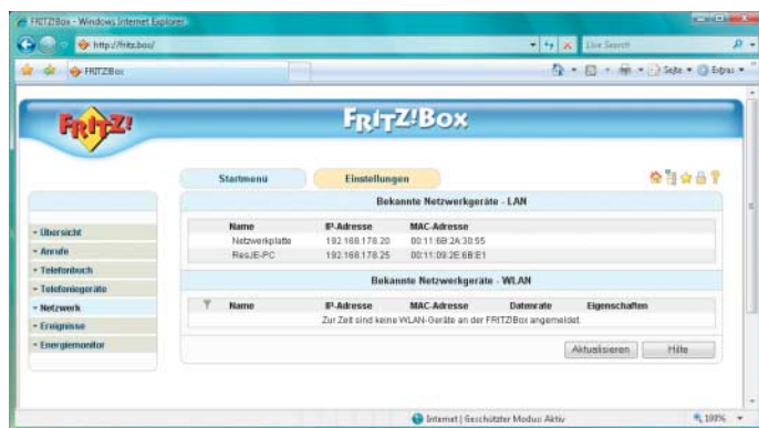
Die DHCP-Server in besseren Routern zeigen an, welche LAN-Station welche IP-Adresse bekommen hat und verraten so die des NAS.
