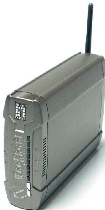
Mit Hilfe eines DynDNS-Dienstes kann man beim Maxtor Central Axis auch von außerhalb per HTTP auf seine Daten daheim zugreifen.
