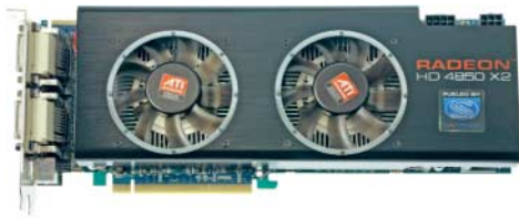
Sapphire verbaut auf der Radeon HD 4850 X2 zwei 7-Zentimeter-Lüfter, die ordentlich Krach machen.
