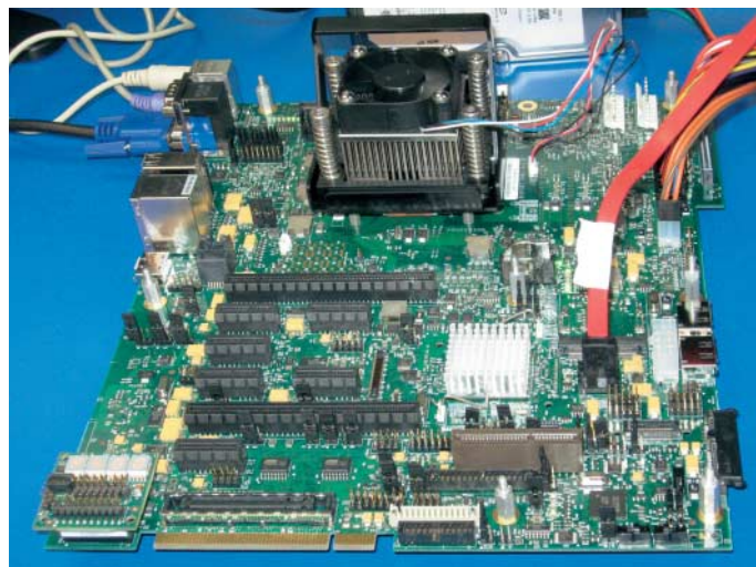
Noch recht unscheinbar und mangels angeschlossener Tastatur und Maus nicht bedienbar, aber immerhin schon lauffähig: ein Prototyp-Board mit Intels Westmere-Prozessor in 32-nm-Technik.
