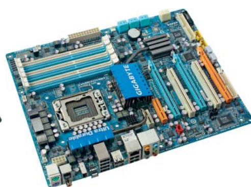
Gigabyte EX58-UD4P: Virtual-Dual-BIOS Gefahr für Daten, TPM-Chip, AHCI-Firmware verlängert Start, eSATA nur über Slotblech
