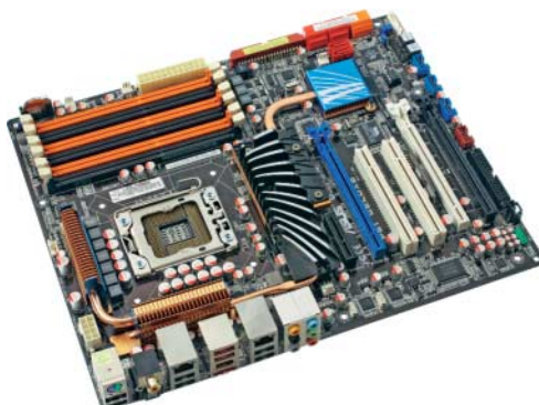
Asus P6T Deluxe: SAS-Controller, lange Bootzeit, Stromsparsoftware teilweise kontraproduktiv, Mini-Linux für integrierte SSD
