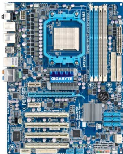
Gigabyte GA-770TA-UD3: eines der ersten Mainboards mit AM3-Fassung und USB-3.0-Adapterchip
