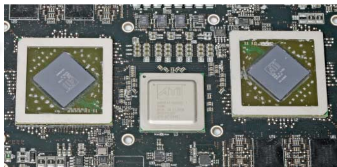
Die beiden RV870-GPUs kommunizieren über einen PCIe-2.0-Switch von PLX miteinander.
