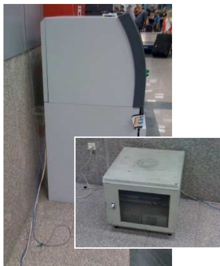
Ägyptischer Bankautomat: Netzwerkkabel frei zugänglich
