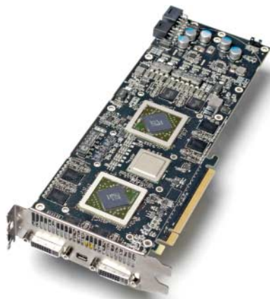
Die beiden RV870-GPUs kommunizieren über einen PCIe-2.0-Switch von PLX miteinander.
