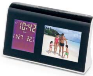
AgfaPhoto AC8130D: kleiner Bilderrahmen mit Radiowecker, aber auch schlechtem Kontrast
