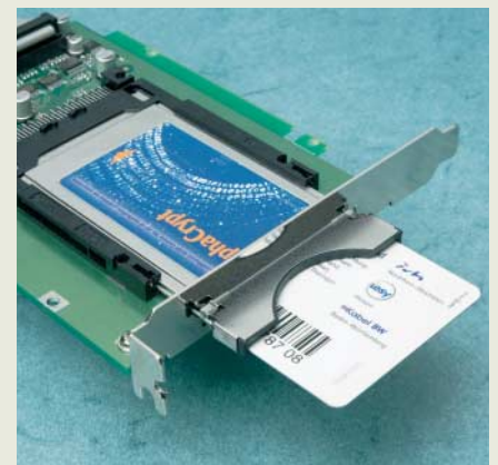
Das Matroschka-Prinzip: Die Smartcard steckt im CAM und dieses wiederum im CI-Slot.
