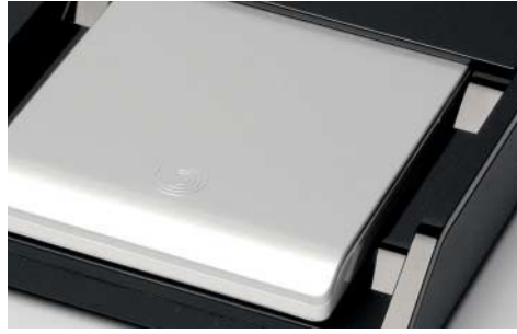
Entfernt man die Abdeckung des Theater+, kann man eine externe 2,5"-Festplatte aus Seagates FreeAgent-go-Serie einschieben.
