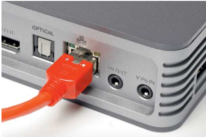
Der WD TV Live lässt sich per Ethernet verkabeln. Die analogen Videoausgänge sind nur per Kabelpeitsche herausgeführt.
