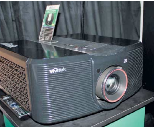
Die LED-Lichtquelle des Vivitek-Beamers soll 20 000 Stunden durchhalten; viele herkömmliche Beamer-Lampen machen schon nach 2000 Stunden schlapp.
