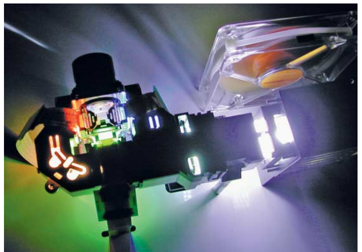
Blick ins Innere eines LCD-Beamers mit Lampe (rechts), Lüfter (oben) und drei Panels, eines für jede Grundfarbe
