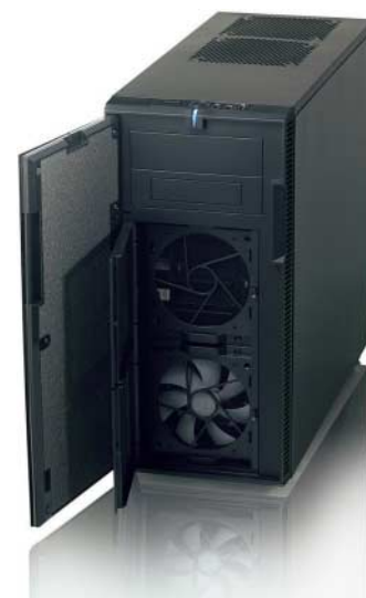
Filter vor dem Frontlüfter des Fractal Design Define R2 verhindern, dass Staub in das Gehäuse gelangt.
