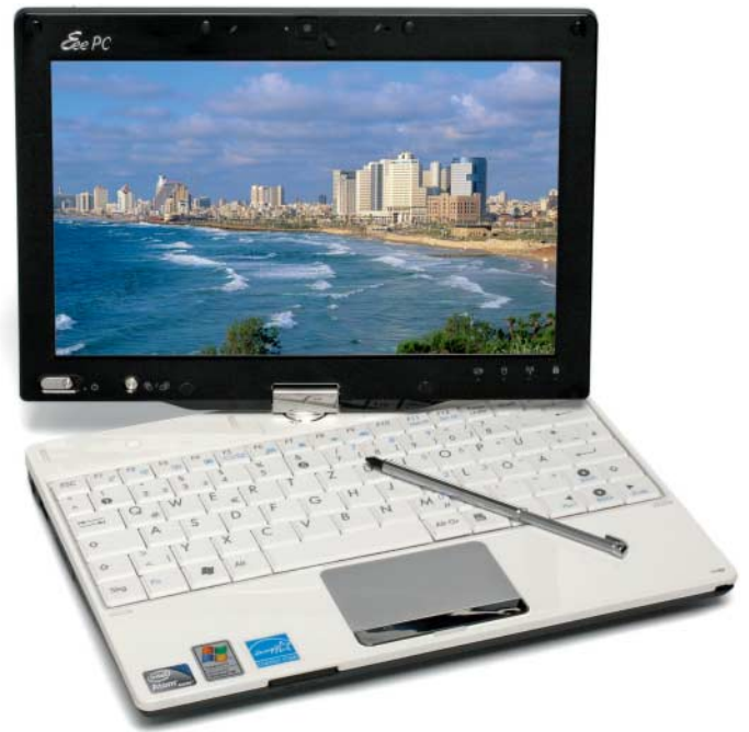
Asus Eee PC T91: kompakt; nur 950 Gramm; Touch-Software; kleine Tastatur; fest eingebauter Akku
