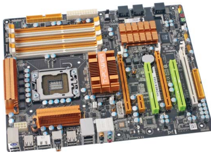
Biostar X58A: gute PEG-Anbindung dank X58, teurer als P55-Boards; negativ: hohe Leistungsaufnahme, schlechte BIOS-Setup-Voreinstellungen, Handbuch dürrig, unzureichende QVL-Liste
