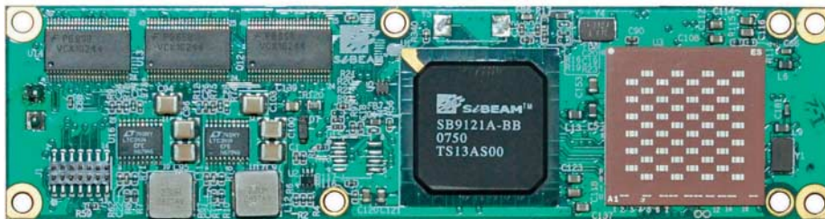
Drahtlos zum Videobild: Rechts auf dem Funkmodul sitzt das Antennen-Array, das die störungsfreie Übermittlung der Funksignale garantieren soll.
