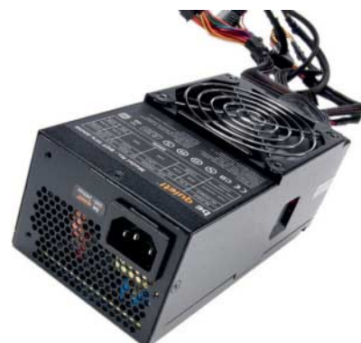
Effiziente 80-Plus-Netzteile gibt es auch im TFX-Format.
