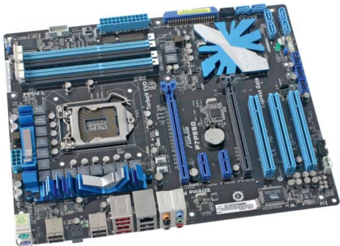
Asus P7P55D: nette DIMM- und PEG-Halterungen, kein SLI, Diagnose-LEDs; negativ: hohe Leistungsaufnahme, langsamer Startvorgang, MemOK! von zweifelhaftem Wert
