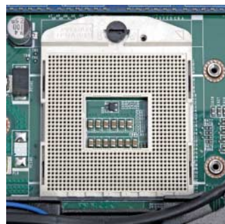
Der Core i7 für Notebooks hat anders als seine Desktop-Geschwister keine LGA-Prozessorfassung, sondern einen ZIF-Sockel und die klassischen Beinchen – 989 insgesamt.
