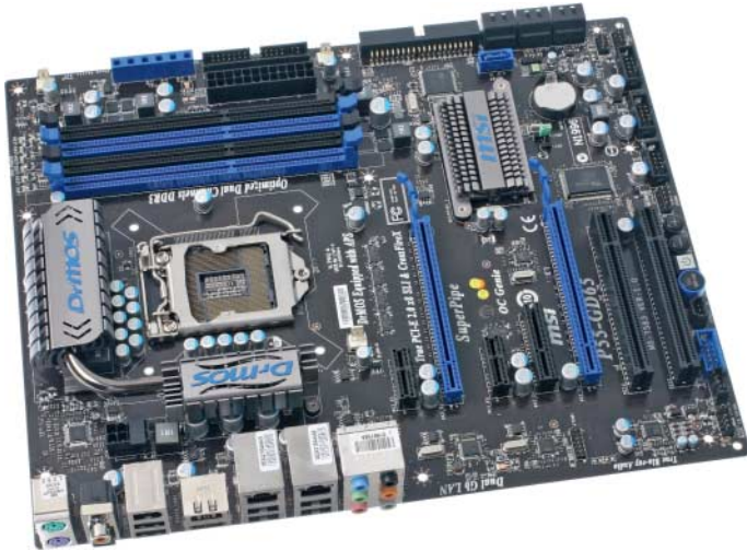
MSI P55-GD65: eSATA/USB-Kombibuchse, zwei LAN-Anschlüsse; negativ: magere USB- und FireWire-Performance, schlechte BIOS-Setup-Voreinstellungen, Mini-Linux mit Sicherheitslücken
