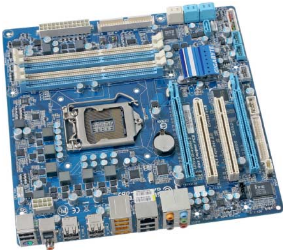
Gigabyte P55M-UD2: günstig, kein SLI, ordentliches Handbuch, nur eine PS/2-Buchse, BIOS schlägt das Aktivieren von AHCI vor, Lüfterregelung automatisch an
