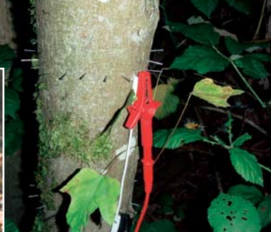
Stahlnägel + Ahornbaum = 10 Mikrowatt. Damit ließen sich zum Beispiel Brandsensoren im Wald betreiben.
