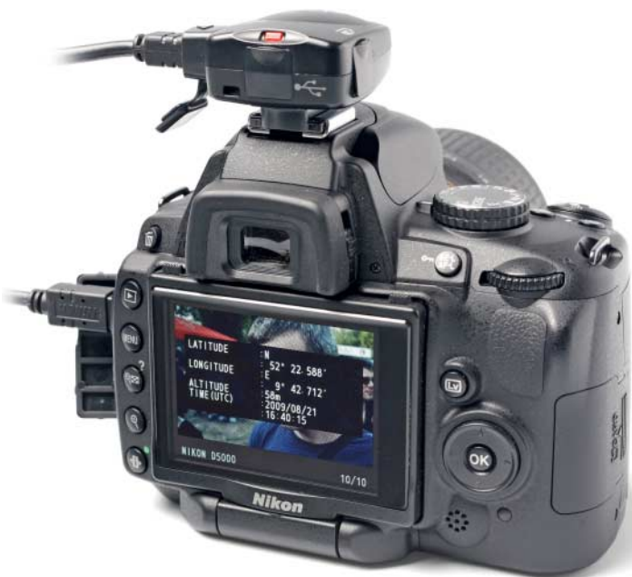
Der Blitzschuh-Tagger GP-1 versorgt Spiegelreflexkameras von Nikon direkt mit Geodaten. Leider ist die Kabelverbindung etwas sperrig.
