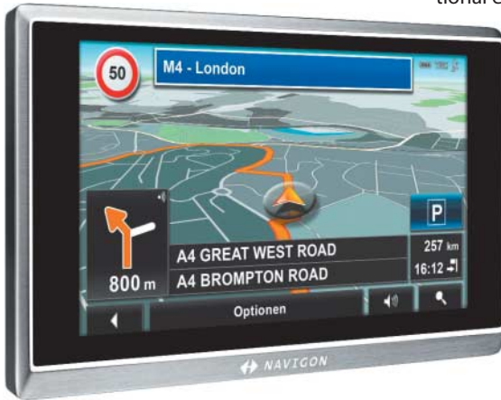
Das Internet-Navi Navigon 8450 zeigt dank Mobilfunkanbindung aktuelle Informationen über Radarfallen, Verkehr, Wetter und Parkplatzauslastung.
