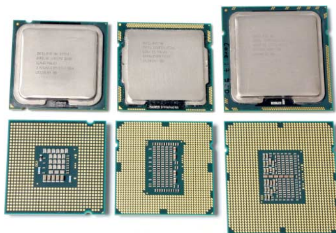
LGA1156-Prozessoren (Mitte) haben fast dieselben Maße wie LGA775-Prozessoren (links), aber rund 380 Kontaktpins mehr; die LGA1366-Technik (rechts) wäre zu teuer für Desktop-PCs.
