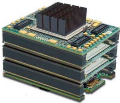
Fünf frei programmierbare FPGAs (auf den mittleren Platinen sitzen je zwei) stapelt Nallatech aufeinander und packt sie auf eine Xeon-Fassung.
