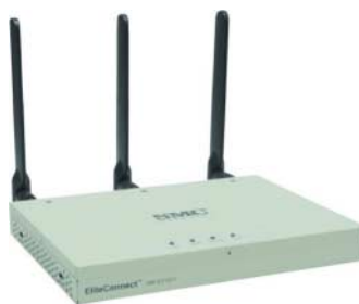
SMCs SMCE21011 baut per Multi-SSID bis zu acht Funknetze auf und versorgt sich über das Ethernet-Kabel mit Strom.
