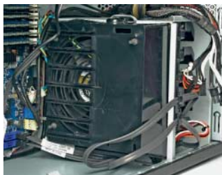
Der meiste Lärm der Thinkstation D20 stammt von einem 12-cm-Lüfter, der so in einem Plastikkäfig eingesperrt ist, dass er kaum Luft ansaugen kann.
