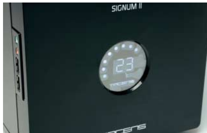
Das berührungsempfindliche LCD dient beim Tacens Signum II zur Lüfterregelung und als Ein- und Ausschalter.
