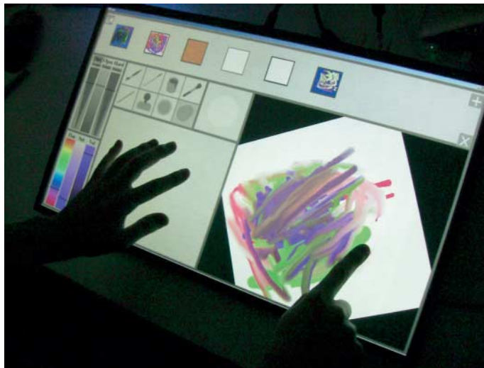
Der druckempfindliche Multitouch-Sensor von Touchco lässt sich jetzt auch transparent herstellen. Damit kann man ihn auch über Displays legen.
