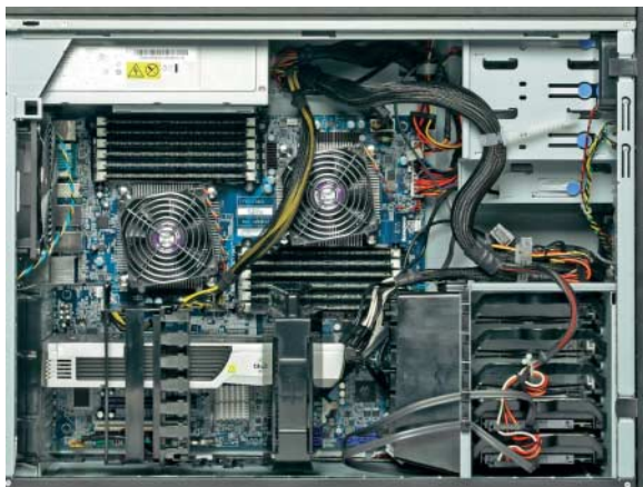
Der meiste Lärm der Thinkstation D20 stammt von einem 12-cm-Lüfter, der so in einem Plastikkäfig eingesperrt ist, dass er kaum Luft ansaugen kann.
