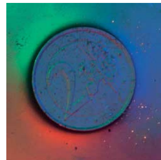
Der GelSight Retrographic Sensor erfasst das Relief eines in weichen Kunststoff gedruckten Objekts.
