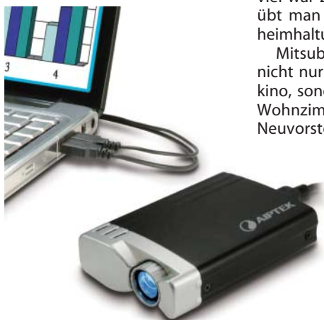
Der Picobeamer T20 von Aiptek lässt sich ohne zusätzliche Stromquelle über zwei USB-Kabel betreiben.
