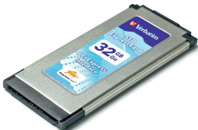
ExpressCard SSDs verschwinden dezent im ExpressCard-Slot des Notebooks. Während es sich bei älteren Modellen nur um verkappte USB-Sticks handelt, arbeiten neuere dank PCI-Express-Anbindung deutlich schneller.
