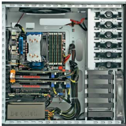
Bei allen drei Rechnern (hier Ultraforce) sind die Kabel sauber verlegt.
