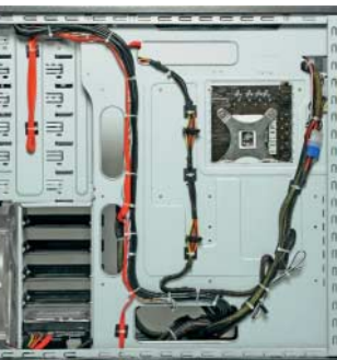
Bei allen drei Rechnern (hier Ultraforce) sind die Kabel sauber verlegt.
