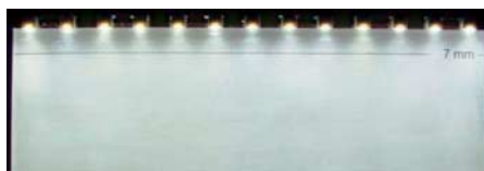
Das Licht der einzelnen LEDs im Notebook wird erst ab etwa 7 mm Abstand zu einer homogenen Lichtfront.
