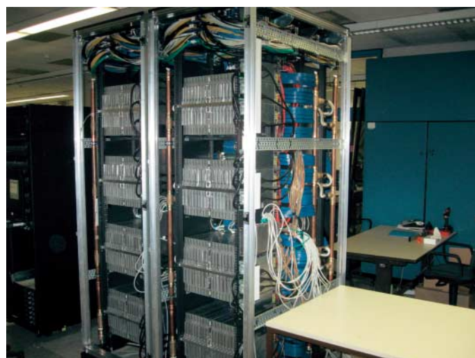
QPACE am JSC – hier noch in Ausbaustufe 1 (zwei Racks mit 512 PowerXCell-8-Prozessoren und 50 Teraflops Spitzenleistung) will im Herbst als Supercomputer mit der besten Energieeffizienz in der Top500-Liste auftauchen.
