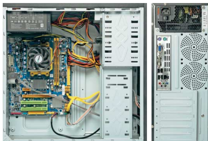
AMD-System: im Leerlauf sparsam und leise, CPU eher langsam, Onboard-Grafik flott
