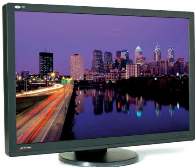
Mit Hilfe des RGB-LED-Backlights zeigt der hardwarekalibrierbare LaCie 730 besonders satte Grundfarben an.
