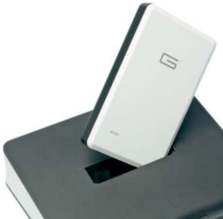
Die Festplatte des MovieCube P800 lässt sich aus dem Player herausziehen und direkt am PC befüllen.
