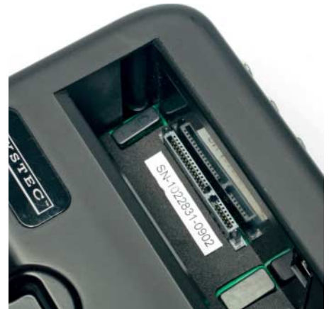
Das Media Dock von Xystec nimmt beliebige SATA-Festplatten ohne Gehäuse auf.
