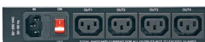
Koukaam NETIO-230A: günstigstes Gerät mit mehreren Ausgängen und Watchdog, http-get-Fernsteuerung funktionierte nicht wie dokumentiert.
