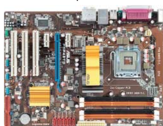
Mehr Kupfer in der Platine: Asus P5P43TD
