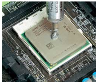
Ein erbsengroßer Klecks Wärmeleitpaste reicht völlig aus (oben). Er verteilt sich durch den Anpressdruck von selbst und vor allem blasenfrei über den Bereich, mit dem der Kühlkörper die Wärme aufnimmt.
