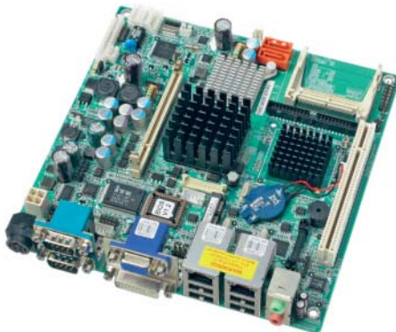
Das eKINO-945GSE von IEI bringt seinen eigenen Spannungswandler mit.
