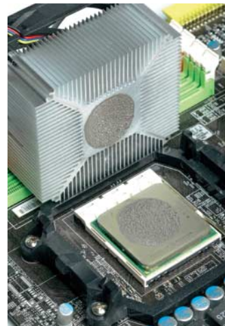
Ein erbsengroßer Klecks Wärmeleitpaste reicht völlig aus (oben). Er verteilt sich durch den Anpressdruck von selbst und vor allem blasenfrei über den Bereich, mit dem der Kühlkörper die Wärme aufnimmt.
