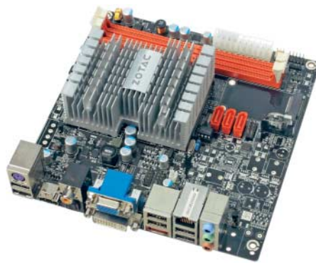
Der Ion-Chipsatz auf dem IONITX-B von Zotac greift der CPU bei der HD-Video-wiedergabe unter die Arme.
