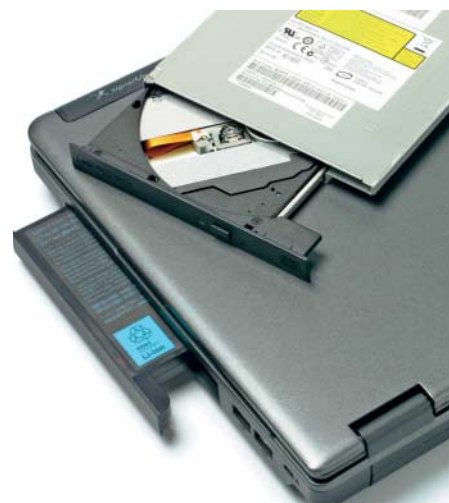
Zweitakku statt DVD-Laufwerk: kompakt, aber meist nicht allzu kapazitätsstark
