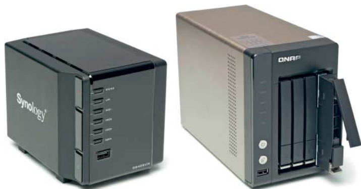
Schicke kleine Kästchen: Das Mini-NAS DS409slim von Synology und das SS-493 Pro von Qnap bieten Platz für jeweils vier 2,5"-Festplatten.
