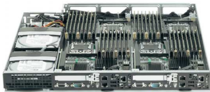
Auf einer Rack-Höheneinheit bringt HP beim ProLiant SL2x170 G6 vier Prozessoren und 32 Speichermodule unter.
