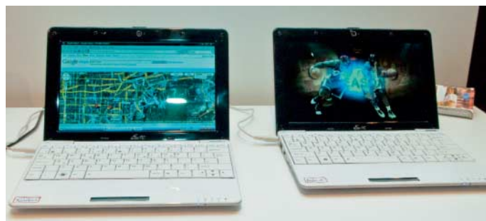
Qualcomm zeigte einen Eee PC von Asus mit ARM-Prozessor. Er ist flacher als die x86-Varianten und hat eine längere Laufzeit.
