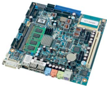
Kontron setzt beim KTUS15/mITX auf Stromspartechnik, die Intel ursprünglich MIDs vorbehalten wollte.
