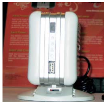
Extra klein: In das winzige Thecus N0204 passen zwei 2,5"-Laufwerke.
