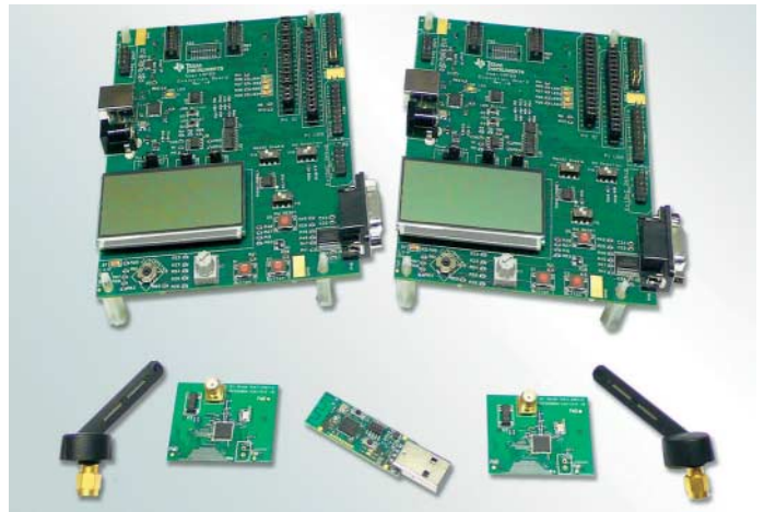
Mal eben schnell ein ZigBee-Sensornetzwerk aufbauen? Das Entwicklungskit für den 2,4-GHz-Funkchip CC2530 enthält alles dafür Benötigte.
