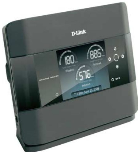
D-Links DIR-685 verbindet Rechner per Kabel und Funk, zeigt Meldungen und Bilder auf seinem Display an und sichert Daten auf einer optionalen Festplatte.
