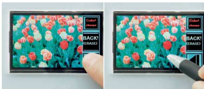
Toshibas LCDs mit auf Pixelebene eingebauten Touchsensoren reagieren auf Abschattungen (links) oder Lichtquellen (rechts).
