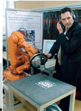
Jens Hofschulte programmiert einen Roboter durch Vormachen der Bewegungen und Spracheingaben.
