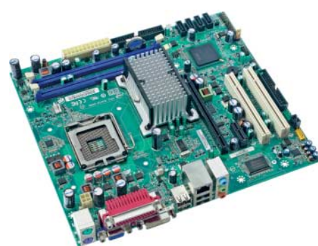
Intel DG41TY mit G41: günstig, maximal 4 GByte RAM, kein Audio via DVI-auf-HDMI-Adapter, geringe Leistungsaufnahme, kein AHCI
