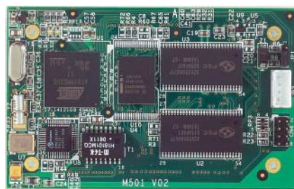
Kaum größer als eine Scheckkarte: Der Einplatinenrechner M-501 läuft unter Linux und lässt sich huckepack auf eigene Platinen oder das Starterkit (oben) stecken.
