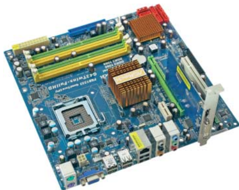
Asrock G43Twins-FullHD mit G43: günstig, DDR3 bringt keine Vorteile, DisplayPort-Anschluss für große Bildschirme, BIOS-Probleme
