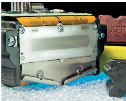
Der Festtintendruckkopf von Xerox soll geschmolzenes Wachs mit 42 Kilohertz abfeuern.
