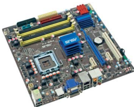
Asus P5Q-VM mit G45: Express Gate braucht lange zum Start, gute Linux-Kompatibilität, ordentliches BIOS, kein HDMI
