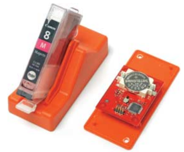
Der „Chip-Redsetter“ setzt den Füllstandsähler bei Canon-Patronen wieder auf „voll“.
