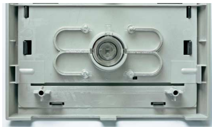
Ermüdungsbruch: Auch bei unserem Medion-PC entdeckten wir einen Bruch am Einschalter. Man darf vermuten, dass dieser Defekt häufiger vorkommt.
