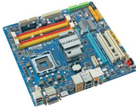
Gigabyte GA-EG45M-UD2H mit G45: guter Onboard-Sound, langsam beim Booten, gute Ausstattung inklusive RAID, eSATA und HDMI
