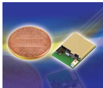
Das nur 12 mm × 16 mm × 2 mm große Funkmodul PAN4555 überträgt Sensordaten mit bis zu 250 kBit/s.
