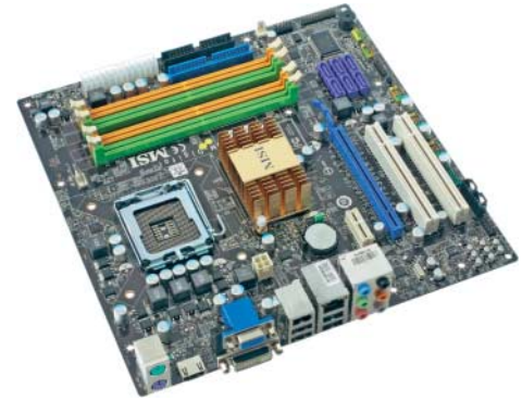
MSI P7NGM-Digital mit GeForce 9300: recht ordentliche Onboard-Grafik, FireWire sehr langsam, magerer Speicherperformance, RAID, HDMI
