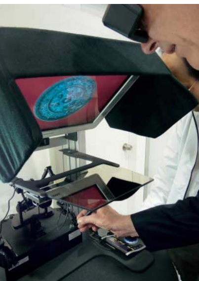
Dieser multisensorische Prototyp des Forschungszentrums NICT liefert neben einem räumlichen Bild auch haptisches Feedback per Stift.
