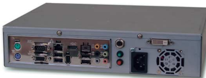
In dem robusten Metallgehäuse des Conception eX steckt eine Mini-ITX-Platine. Der DVI-Port hängt an einer Mini-PCI-Karte.
