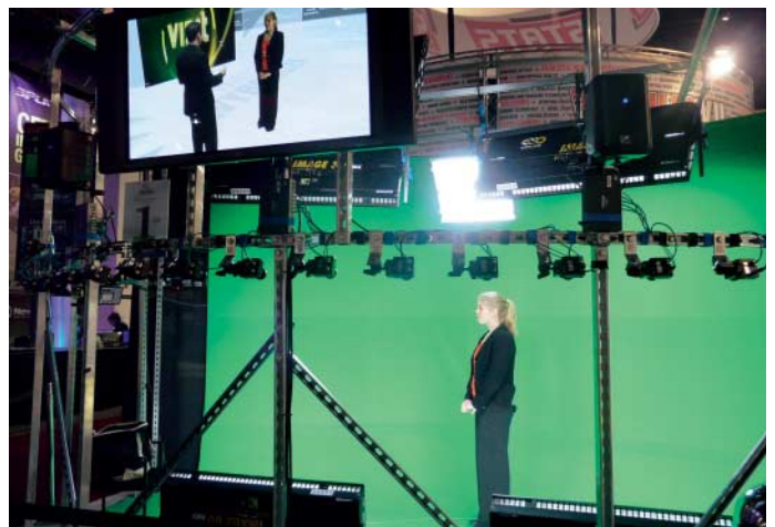
TV-Moderatorin mit Trackingsensoren: Aus 24 Kamerabildern entsteht ein virtuelles 3D-Abbild.
