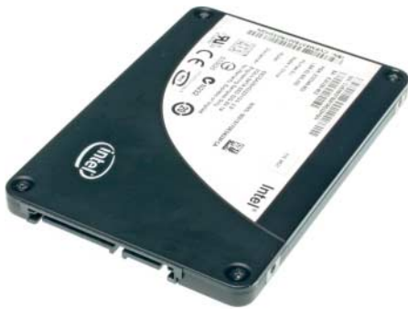
Intel X25-E: für den Servereinsatz konzipiert, hohe Mean Time Between Failures von zwei Millionen Stunden, sehr schnell, aber auch teuer durch SLC-Flash
