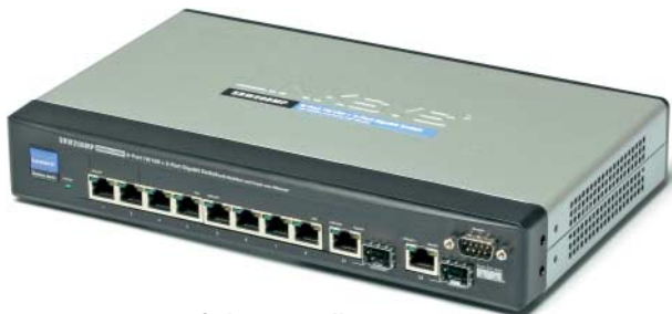
Cisco SRW208MP: ausgefeilte Einstellmöglichkeiten, dadurch auch für Admins größerer Netze reizvoll, gute Dokumentation
