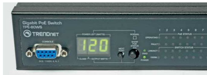
Die 7-Segment-Anzeige an Trendnets TPE-80WS meldet die noch verbleibende PoE-Leistungsreserve, alternativ auch die PoE-Klasse und gezogene Leistung an jedem Port.
