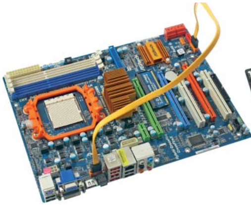
Asrock M3A790GXH/128M: dritter PEG-Slot mehr Schein als Sein, krude eSATA-Verkabelung, Dual-Link-DVI und HDMI
