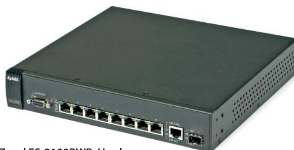
Zyxel ES-2108PWR: Hardware-Monitor, zahlreiche Konfigurations- und Überwachungsoptionen, aber nur wenige für PoE
