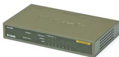
D-Link DES-1008P: nicht konfigurierbar, geringe Leerlaufleistungsaufnahme, PoE-Defekte
