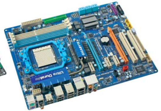
Gigabyte GA-MA790XT-UD4P: PWM-Signal der Lüfterregelung sehr unsauber, lange Startzeit, eSATA per Slotblech
