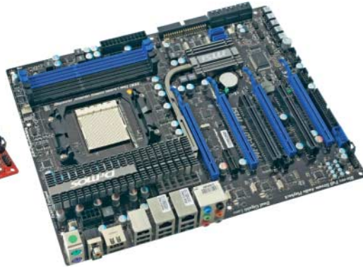
MSI 790FX-GD70: teuer, vier gut angebundene PEG-Slots, Post-80-Ausgabe, viele SATA-Anschlüsse, USB langsam
