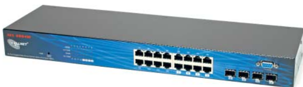
Allnet ALL4804W: kann Konfiguration nicht speichern, Fernüberwachung per SNMP, wegen fehlendem STP schlecht in größere LANs integrierbar
