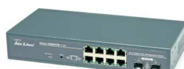
Ovislink Ether-GSH8TW+: mit MiniGBIC-Slots, MAC-Tabelle per Telnet auslesbar und per SNMP überwachbar, aber schwache Dokumentation
