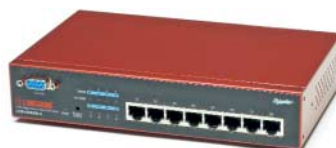
Longshine LCS GS8208-A: geringe FE- und GE-Leistungsaufnahme, aber Schwächen bei Gigabit-Volllast in den RFC-Messungen
