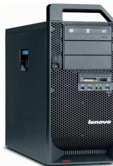
Das Gehäuse der Dual-CPU-Workstation Lenovo Thinkstation D20 besteht zu 30 Prozent aus Recycling-Kunststoff.
