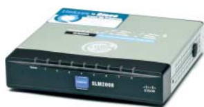
Cisco SLM2008-EU: Stromversorgung übers LAN-Kabel, beherrscht neben Trunking und RSTP sogar 802.1x, brauchbare Dokumentation
