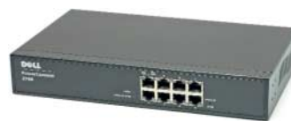
Dell PowerConnect 2708: im Gigabit-Betrieb stromhungrig, mit Online-Hilfe im Web-Interface, Garantie kostenpflichtig verlängerbar
