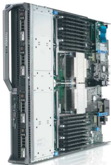
Bis zu 18 Speicherriegel passen in den 2-HE-Server PowerEdge M710 von Dell.
