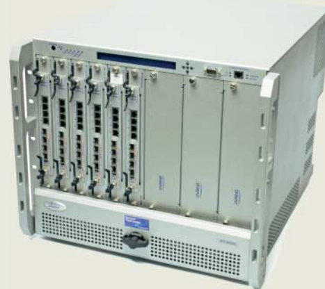
Spirents Chassis SPT-9000 nimmt bis zu 12 Karten mit unterschiedlicher Port-Bestückung auf. Im Maximalausbau kann man damit 144-Port-Gigabit-Switches testen.
