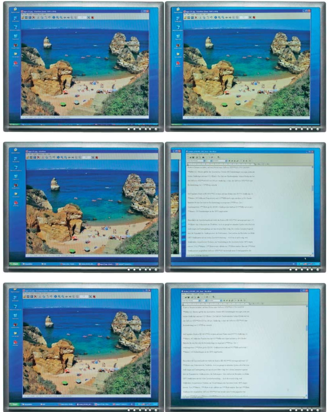
Der Bildschirminhalt lässt sich auf einem zweiten Monitor duplizieren (Clone-Modus, Bild oben), horizontal oder vertikal auf zwei Bildschirme aufspannen (Span, Bild Mitte) oder um eine Arbeitsfläche erweitern (Dual-View, Bild unten).
