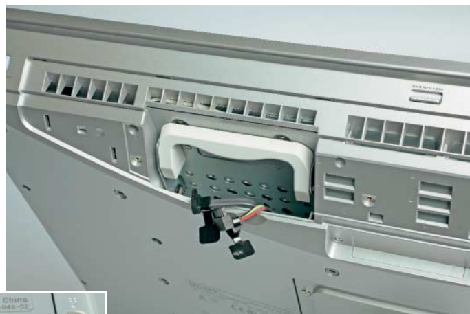
Hinter einer Abdeckklappe bietet der Sony Platz für eine weitere SATA-Festplatte.
