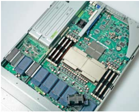
Intel schickte ein schlankes 1U-Rack-mount-System von Asus zum Test, das theoretisch bis zu 192 GByte Speicher (mit 16-GByte-Modulen) aufnehmen kann.
