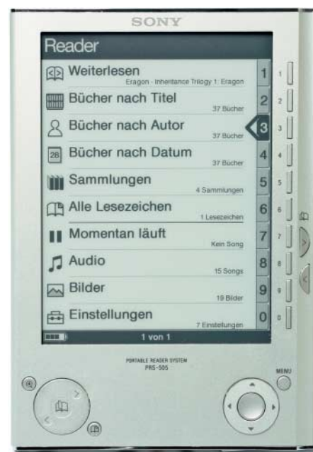
Die zehn Knöpfe auf der rechten Seite aktivieren den entsprechenden Menüpunkt.
