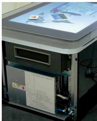
Unter der Gehäuseabdeckung des Surface kommt ein konventioneller PC zum Vorschein.
