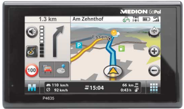
Das Navi Medion GoPal P4635 enthält eine Mobilfunkkarte und holt sich Daten über Verkehr und Wetter aus dem Internet.
