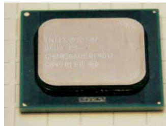
Für besonders raue Einsatzbedingungen verpackt Intel Atom-Prozessoren in ein etwas größeres Gehäuse mit Heat-Spreader und validiert sie für Temperaturen zwischen -40 und +85 °C.
