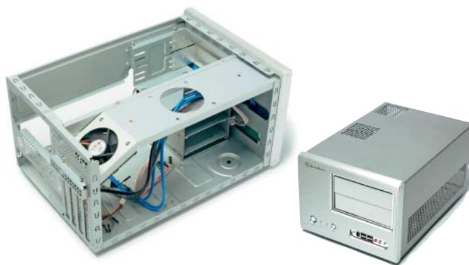
Die Lüfter des Silverstone Sugo SG01-F sorgen für einigen Lärm. Dank 3-Pin-Stecker lassen sie sich an die Regelung des Mainboards anschließen.
