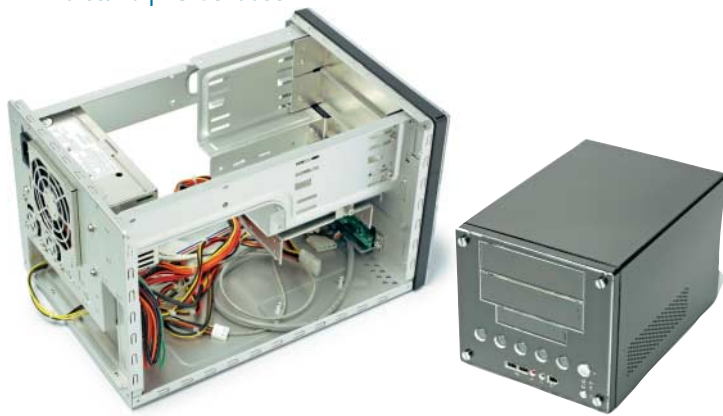
Ein eingebautes Geduldsspiel bietet das Morex Venus CP668: Die Kontakte der Frontanschlüsse müssen einzeln den Mainboard-Pins zugeordnet werden.
