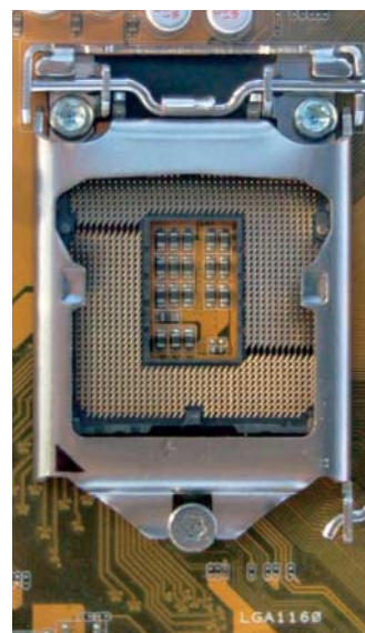
Neue CPU-Fassung für den „Lynnfield“: Auf der Platine steht zwar LGA1160, auf dem hier entfernten Schutzdeckel aber LGA1156.
