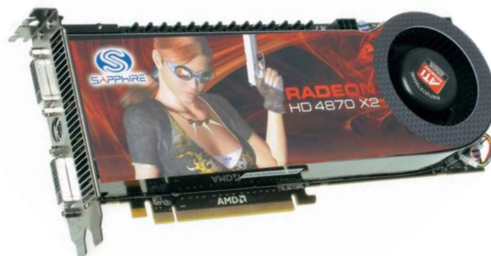
Doppelturbo: Grafikkarten mit zwei GPUs bringen es auf über 2 TFlops theoretische Rechenleistung.
