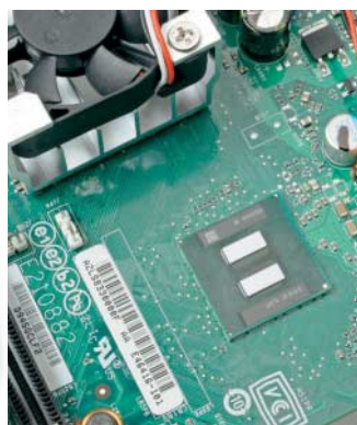
Der Doppelkern Atom 330 besteht schlichtweg aus zwei einzelnen Siliziumplättchen.
