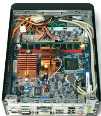
Im Barebone Shuttle X27 steckt ein Mini-ITX-Mainboard – eines der wenigen Atom-Boards mit DVI-Buchse.
