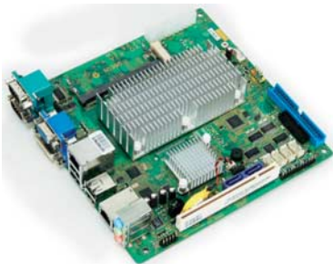
Mainboards wie das IM-945GSE mit Atom N270 sollen sich ohne Lüfter kühlen lassen.
