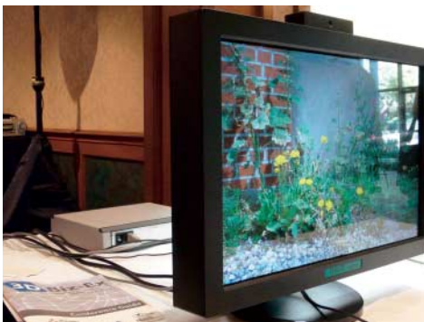
Der Display-Prototyp „Free2C“ vom HHI erzeugt stereoskopische Bilder, deren 3D-Eindruck ohne spezielle Brille wahrnehmbar ist.
