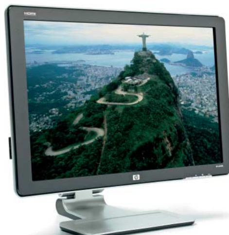
Auf seinem gelenkigen Standfuß lässt sich HPs w2408h drehen, neigen und in der Höhe verstellen.
