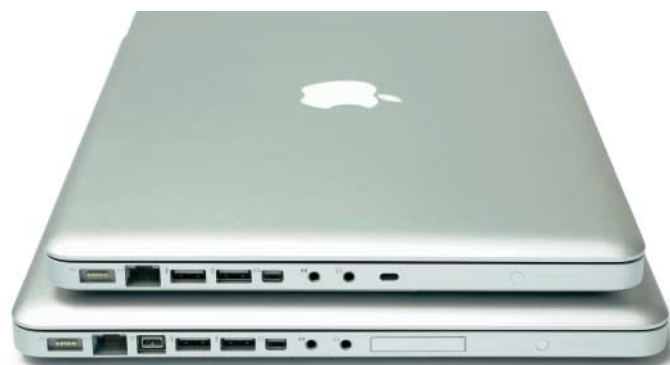
Die Schnittstellen liegen alle an der linken Seite, sodass die Books mit angeschlossener Peripherie weniger Platz benötigen.
