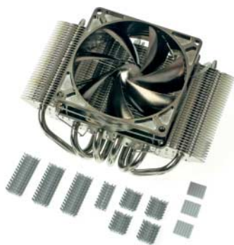
Der Thermalright HR-03 GT bietet zwei Montagemöglichkeiten, bei der Lüfteranordnung oberhalb der Karte bekommen die Spannungswandler aber keine Kühlluft ab und überhitzen.
