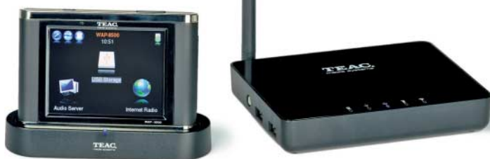
Teacs UPnP-AV-Streaming-Client WAP-8500 besteht aus einer schlichten Decoder-Box und der schicken Touch-Fernbedienung.
