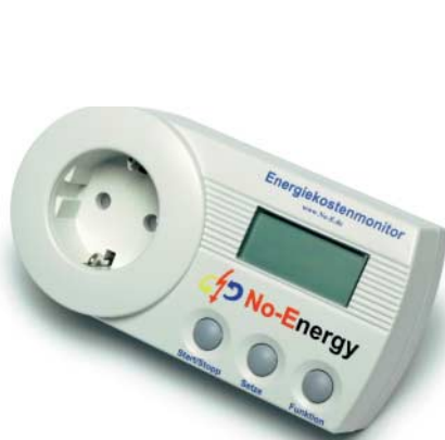
NZR No-Energy: kleinster Fehler an unseren Testlasten, zeigte selbst beim leerlaufenden Notebook-Netzteil noch halbwegs richtig an
