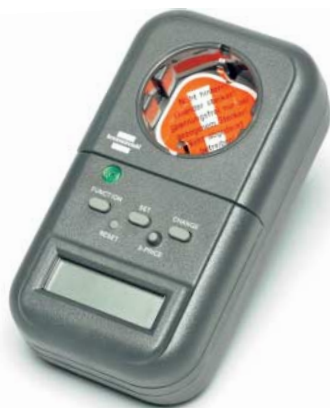
Brennenstuhl PM 230: Auslaufmodell, versagte bei nichtlinearen Verbrauchern, errechnet Energiekosten für zwei Tarife
