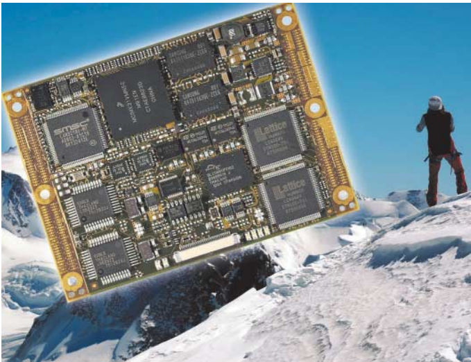
Das CPU-Modul EXM-IMX31 eignet sich für die Datenakquise auch an besonders kalten oder heißen Orten.
