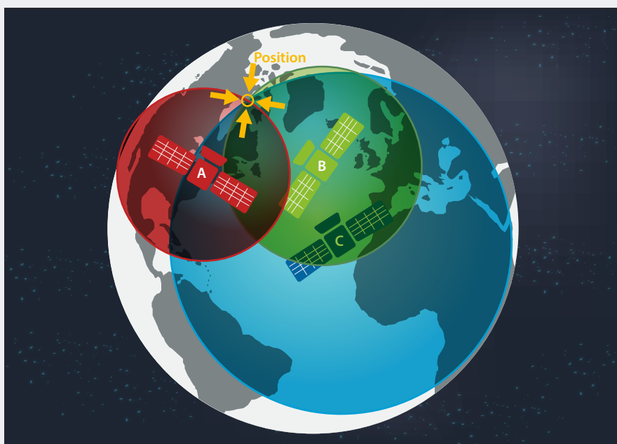
Die Ortsbestimmung ist eigentlich eine Laufzeitmessung. Mit drei Signalen exakt gleicher Laufzeit und mit einem Signal zum Zeitvergleich als vierter Komponente ist eine Position bestimmt.
