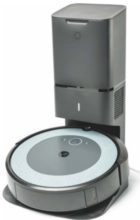
Die Basisstation ist mit einem eigenen Sauger nebst Staubsaugerbeutel ausgestattet und zieht den Schmutz aus dem Auffangbehälter des i3+.
