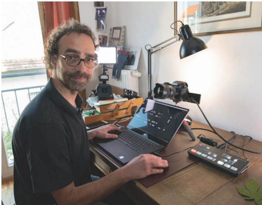
Der kompakte Videomischer Atem Mini von Blackmagic Design bindet die Lumix-Fotokamera als Webcam ein. Sie liefert bessere Bildqualität und mehr Tiefenschärfe als jede integrierte Kamera.
