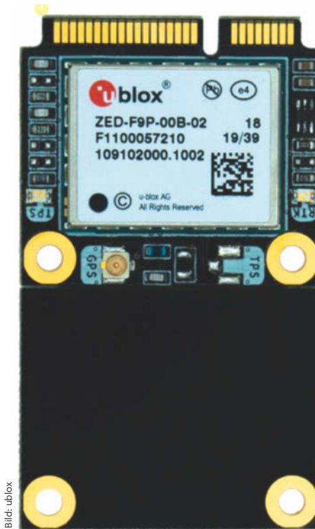
Das ublox-Modul ZED-F9P ist mit 170 Euro einigermaßen erschwinglich. Es gibt dafür auch fertige Entwickler-Boards, einige andere integrieren das Modul bereits ebenfalls.
