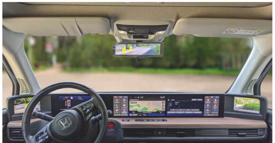
Sechs Displays im Blick: Selbst der Rückspiegel ist digital. In einem Kleinwagen stellt das ein Novum dar.
