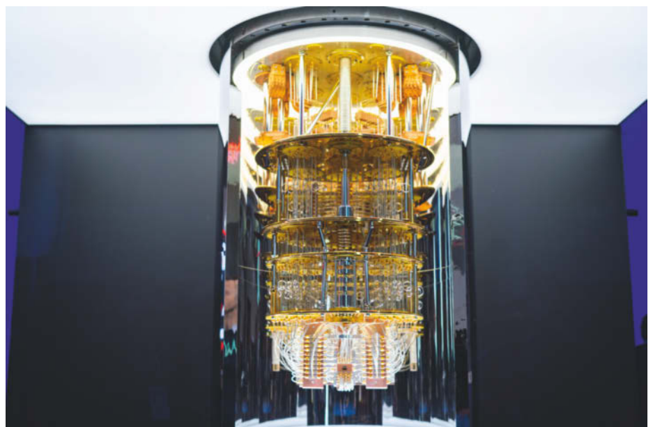
Der Q-System-One-Quantencomputer: Ohne den ultratiefkühlenden Kryobehälter ist unten der Chip zu erkennen, der 27 supraleitende Qubits beherbergt.
