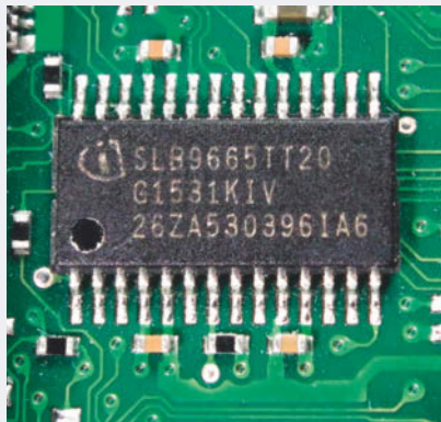
Chip des Anstoßes für viele Leser der c't 16/2021: Microsoft verlangt für Windows 11 ein Trusted Platform Module (TPM) wie den abgebildeten Chip von Infineon.
