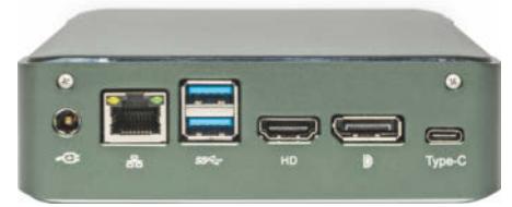
Anschlussfreudig: Der NitroPC bietet zahlreiche Ports, darunter USB-C mit USB 3.2 Gen 2x2.
