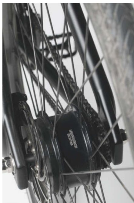
Schön unauffällig: Gleich drei der fünf E-Bikes im Test verwenden einen Hinterradnabenmotor, wie hier das Angell.
