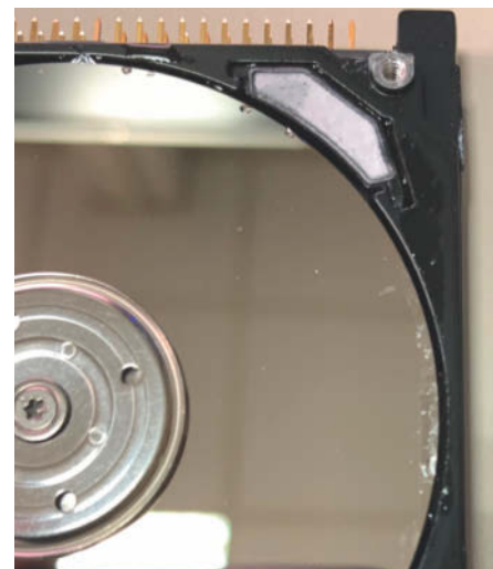
Ältere Festplatten nutzen statt Aktivkohle einen Papierfilter. Der hält das Wasser nicht auf, dieses Laufwerk wäre ein Fall für den Datenretter gewesen.
