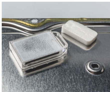
Der Aktivkohlefilter dieser Festplatte ist beim Tauchen zwar feucht geworden, hat aber kein Wasser in das Innere durchgelassen.
