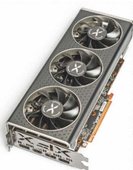
Die XFX Radeon RX 6600 XT ist ab Werk leicht übertaktet, hat drei Lüfter und belegt etwas mehr als zwei Steckplätze.
