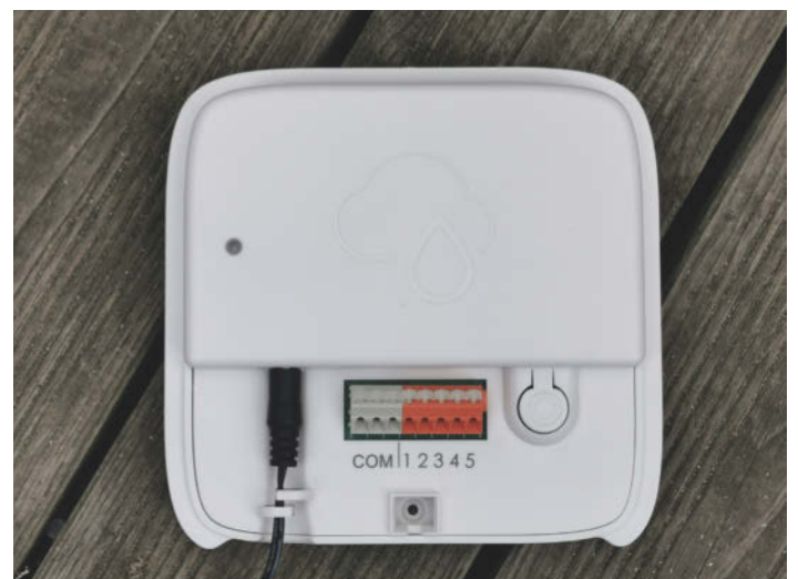
Die Bridge von Cloudrain bietet Anschlüsse für bis zu fünf 24-Volt-Ventile, die sich über die App schalten lassen.
