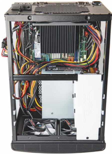
Der selbst gebaute Mini-ITX-Server hat ECC-RAM und Fernwartung und ist noch kompakt.
