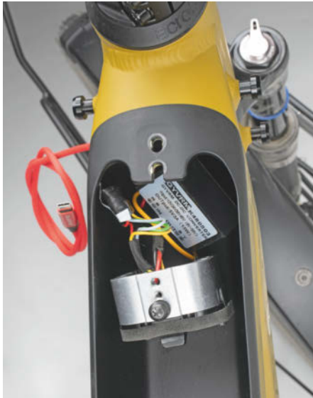
Der Spannungsregler findet bequem Platz hinter dem Anschlussblock für den Akku im oberen Rahmenrohr.
