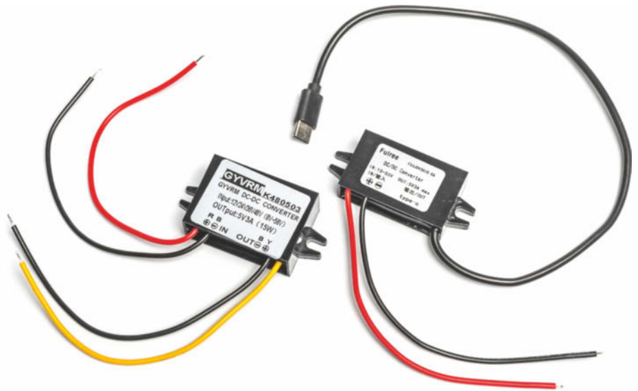
Passende 5-Volt-Wandler gibt es witterungsfest vergossen als Module von verschiedenen Herstellern.
