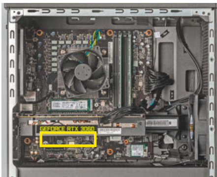
Das Innere des Legion T5 wirkt aufgeräumt. Unterhalb der Grafikkarte ist noch ein freier M.2-Steckplatz vorhanden, in den eine zweite NVMe-SSD passt.
