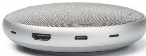
Die Konferenzlautsprecher werden per USB oder Bluetooth angesteuert. Der Dell ist zusätzlich eine USB-C-Dockingstation inklusive PowerDelivery.
