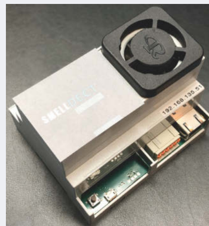
Eine E-Nase als Modul für den industriellen Einsatz besteht aus einem Sensorchip, Elektronik und Lüftung.
