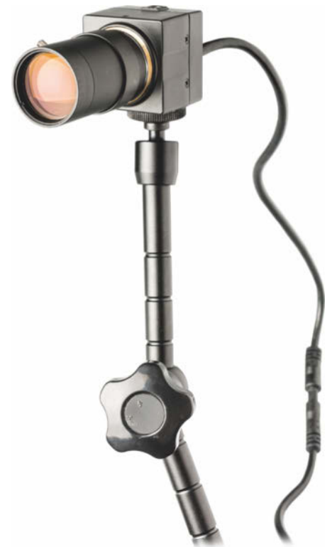
Die ELP USBFHD06H hat oben und unten je ein 1/4-Zoll-Stativgewinde. Ein Klemmstativ erlaubt flexible montage.
