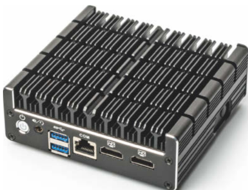
Die einzelne RJ45-Buchse vorn am Yanling NUC-C3 ist eine serielle Schnittstelle. Seine vier Gigabit-Ethernet-Ports sitzen hinten.
