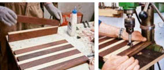
Nach dem Verleimen der Hölzer wird das typische Eierloch hineingefräst
