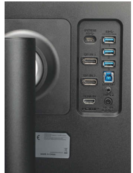
Der USB-C-Port im OLED-Monitor überträgt Videodaten und lädt angeschlossene Mobilgeräte mit bis zu 90 Watt.
