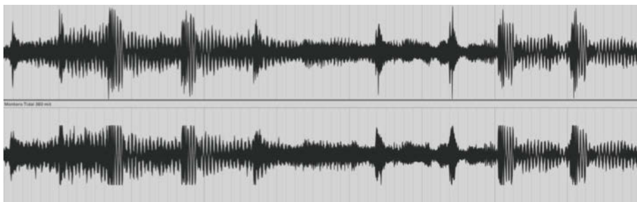
Die Automatik von Tidal hob die Lautstärke des 360RA-Songs „Montero“ von Lil Nas X um 4 dB an. Wie unten bei angepassten Pegel zu sehen ist, wurden dadurch Pegelspitzen abgeschnitten, was die Dynamik zerstört.
