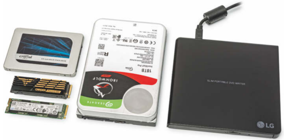
Gruppenbild mit optischem Laufwerk (rechts): Letzteres spielt für viele PC-Nutzer kaum noch eine Rolle. Umso mehr aber die kleinen SSD-Kärtchen im M.2-Format (links Mitte, unten). Sie gehören unter den schnellen Flash-Speicher auch zu denjenigen mit dem günstigsten Preis pro GByte.
