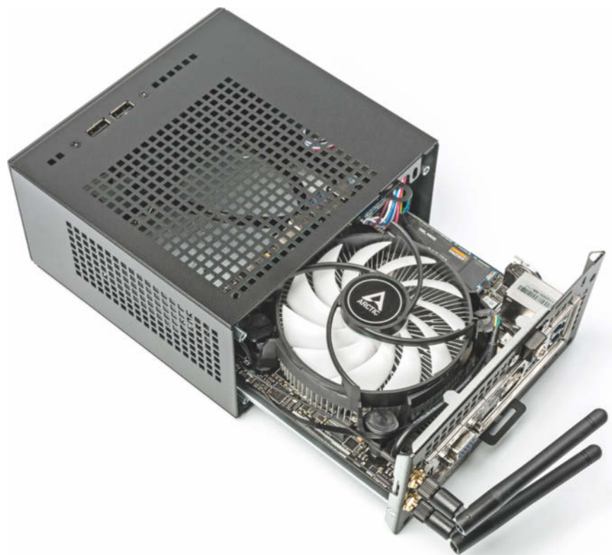
Das Board mit der gesamten Hardware sitzt im iDeskMini auf einem herausziehbaren Schlitten. Den brummigen Boxed-Kühler von Intel haben wir durch ein leiseres Modell ersetzt.
