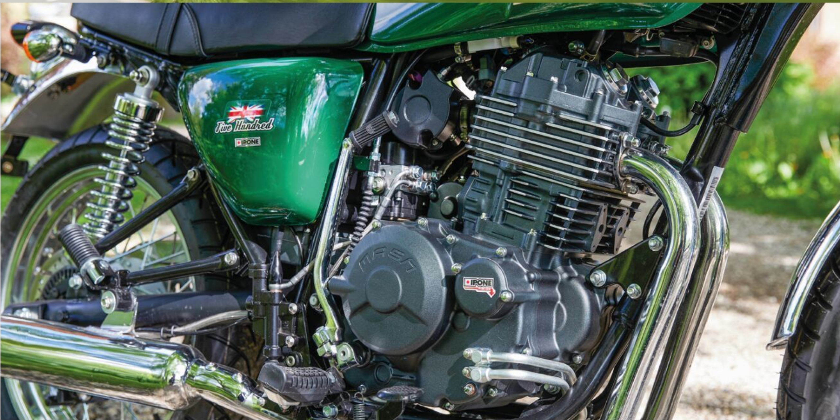
Sorgt für leuchtende Nostalgiker-Augen: Der 400er-Einspritzer hat noch einen Kickstarter.
