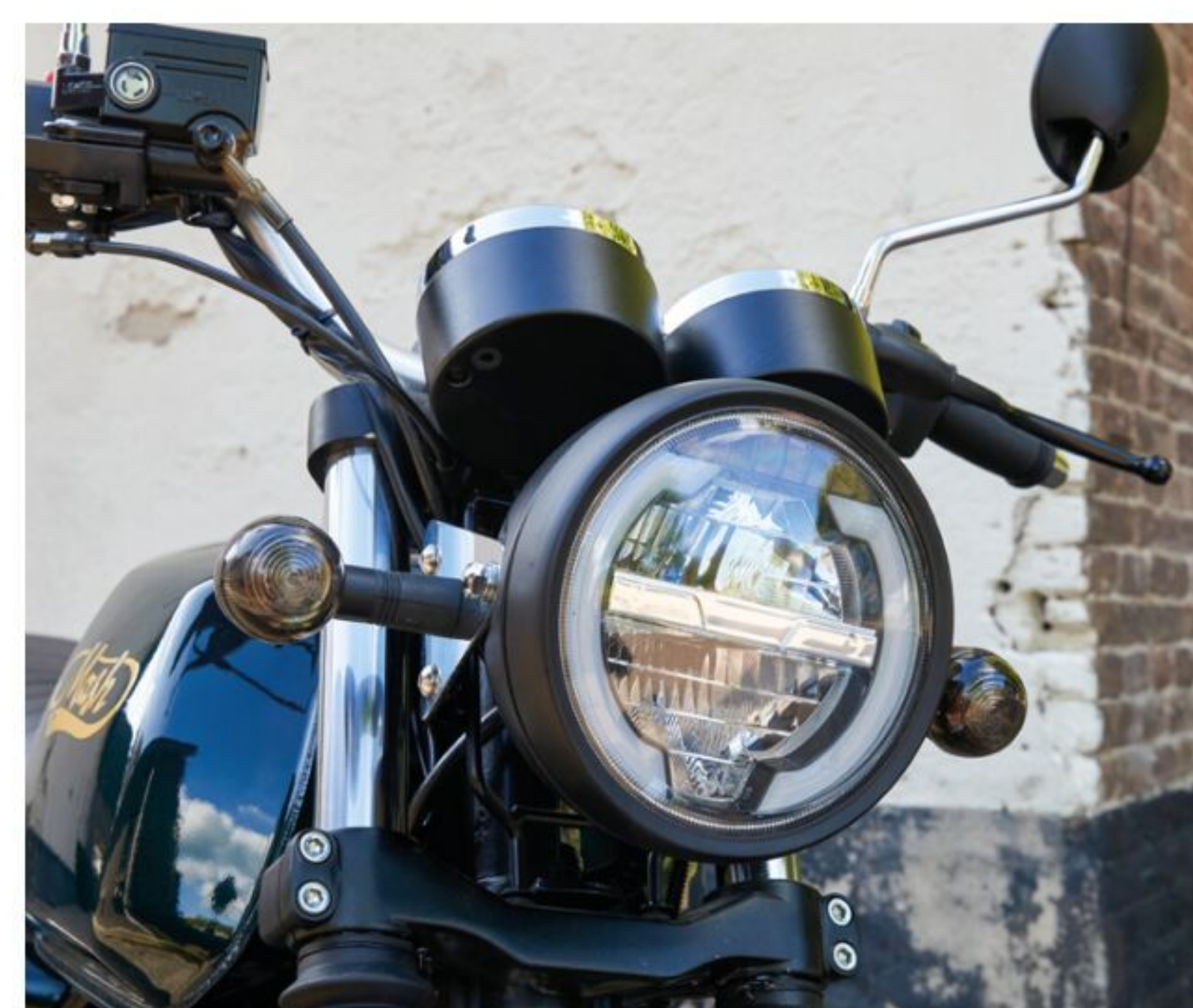
Ein LED-Scheinwerfer und schwarz ummantelte Stahlflexleitungen gehören zur Serienausstattung.
