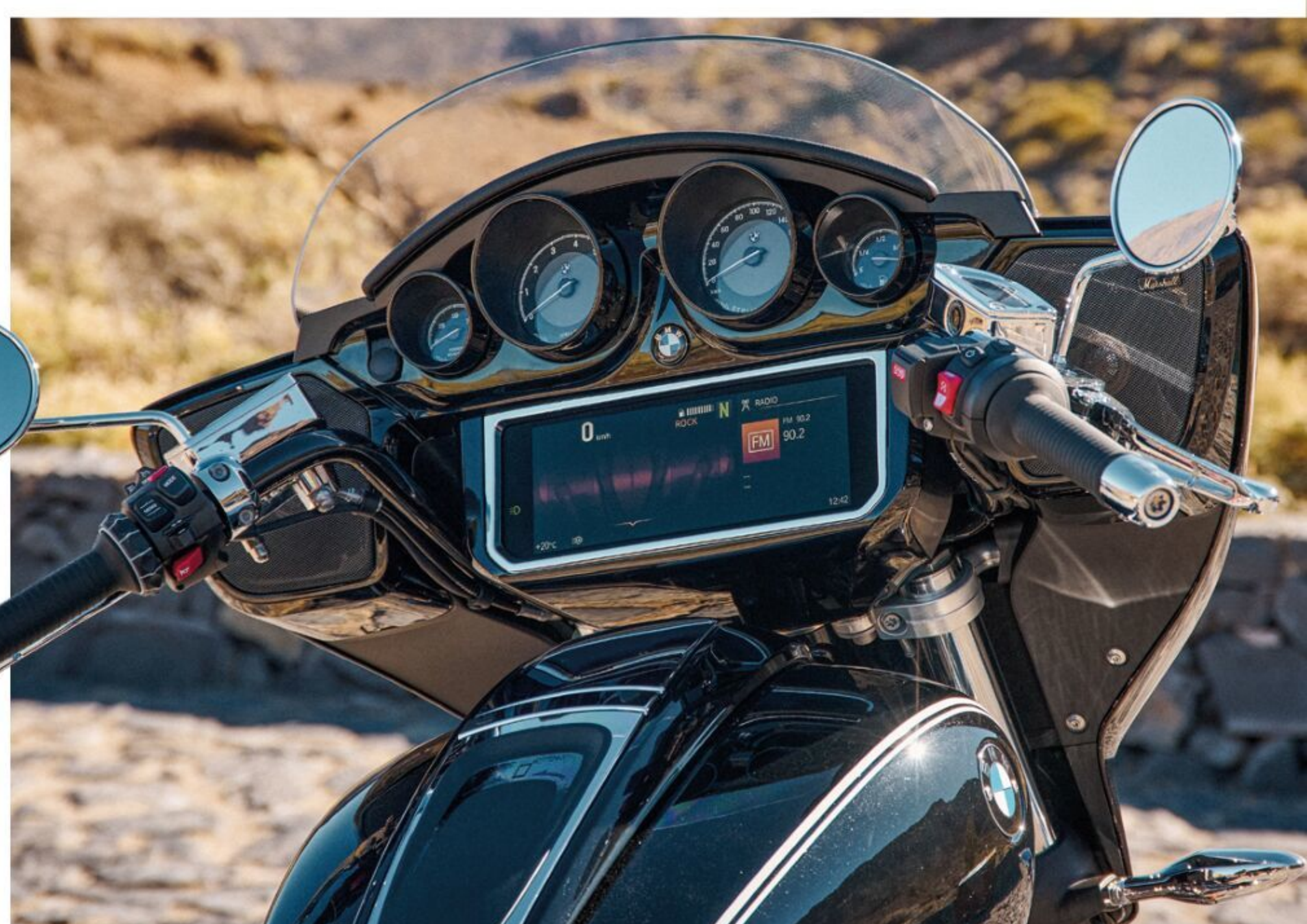
Volles Programm: vier Rundinstrumente plus 10,25-Zoll-Farb-TFT plus zwei Boxen von UK-Spezialist Marshall.
