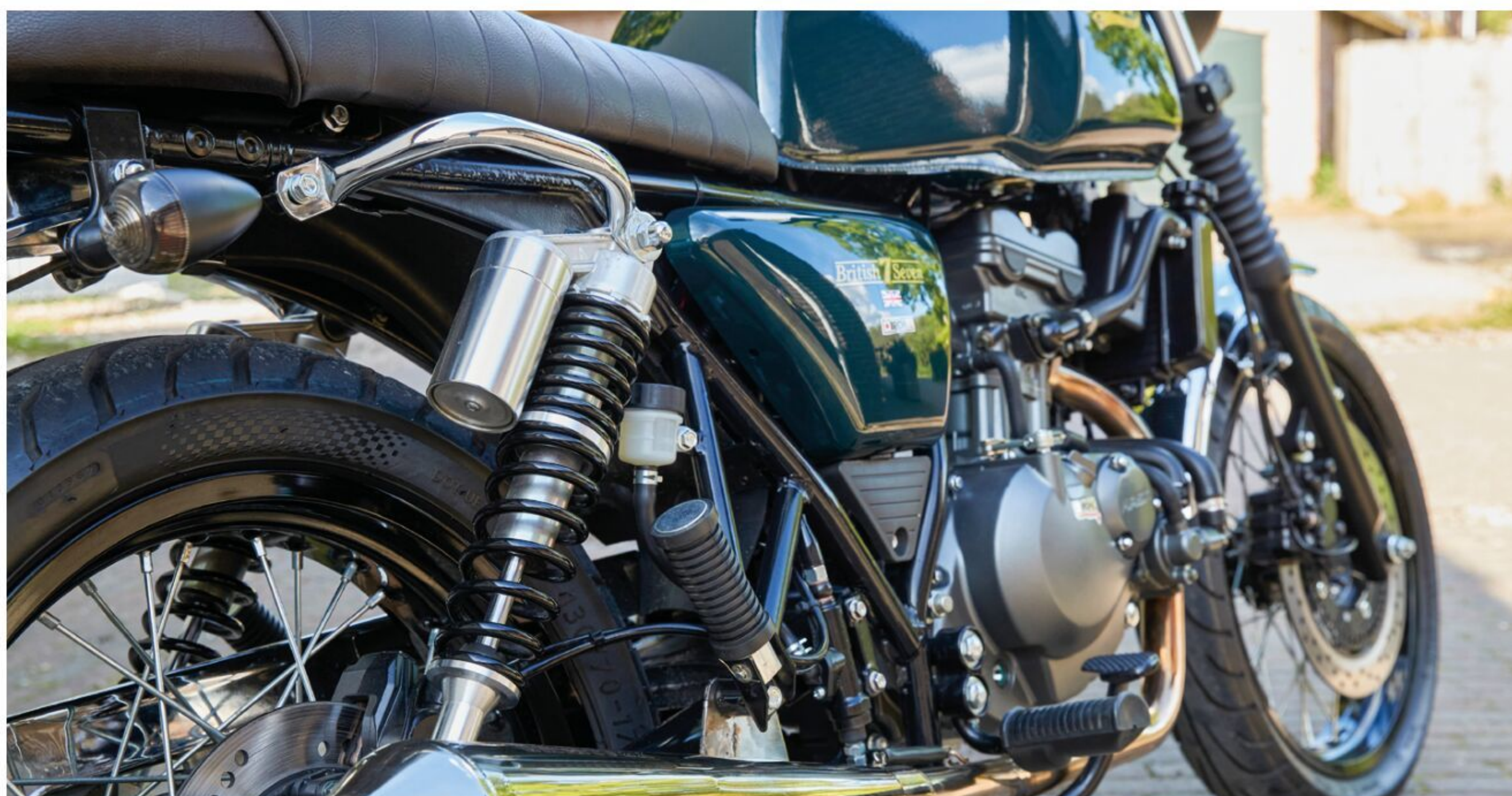
Die Federvorspannung der Stereofederbeine mit externem Ausgleichsbehälter ist einstellbar.
