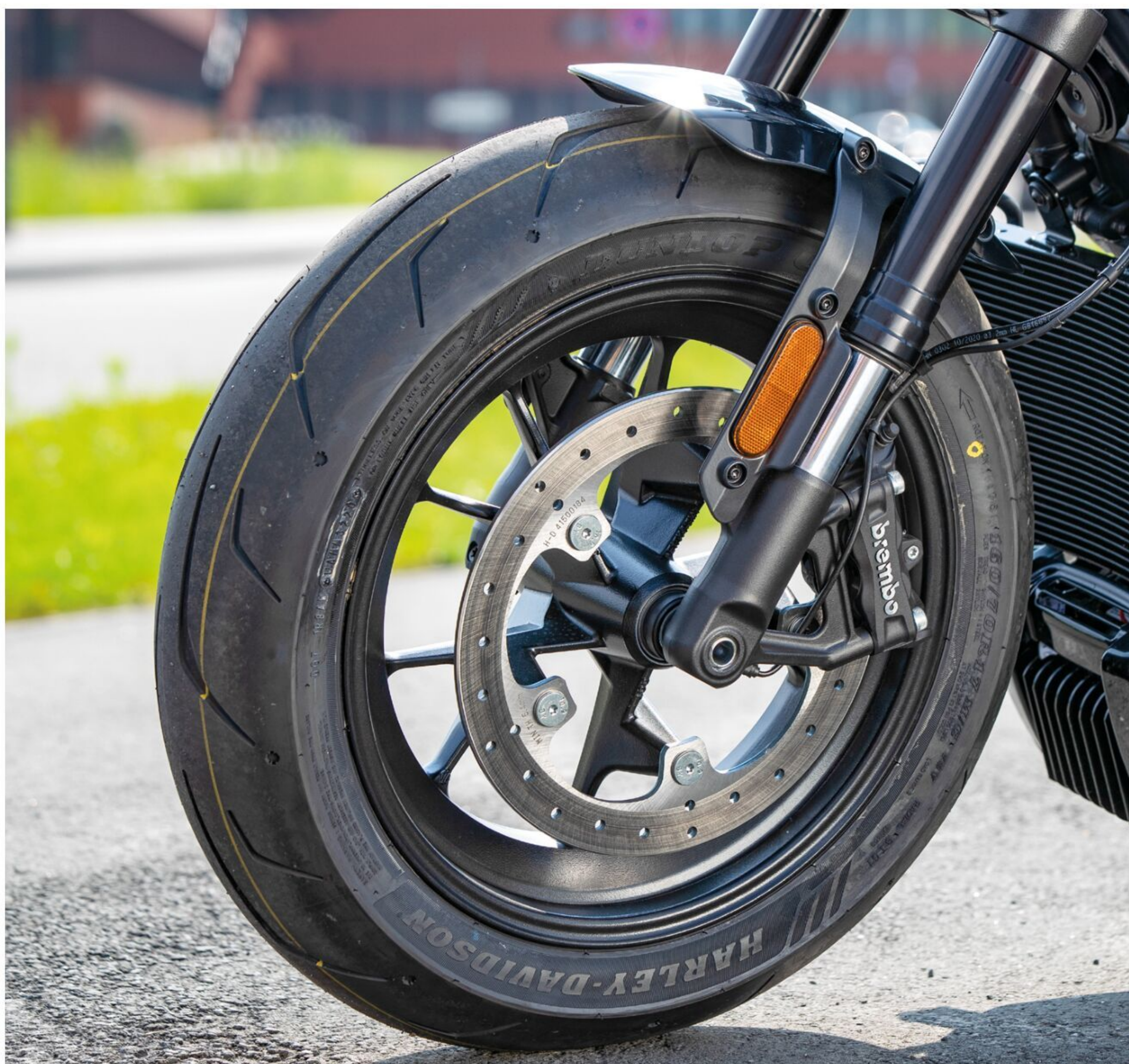
Die mit radial montierter Vierkolbenzange bestückte 320er-Brembo-Scheibe hat ausreichend Biss.
