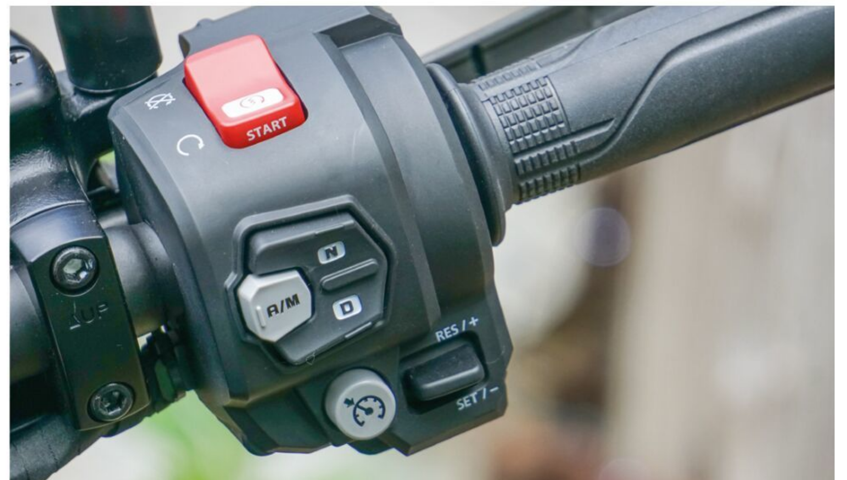
Bedienelemente: links „Mode“-Taste zum Wechseln der Fahrmodi, Feststellbremse rechts neben der Armatur. Rechts: Schaltwippe für Fahrmodus (D), Tempomat serienmäßig
