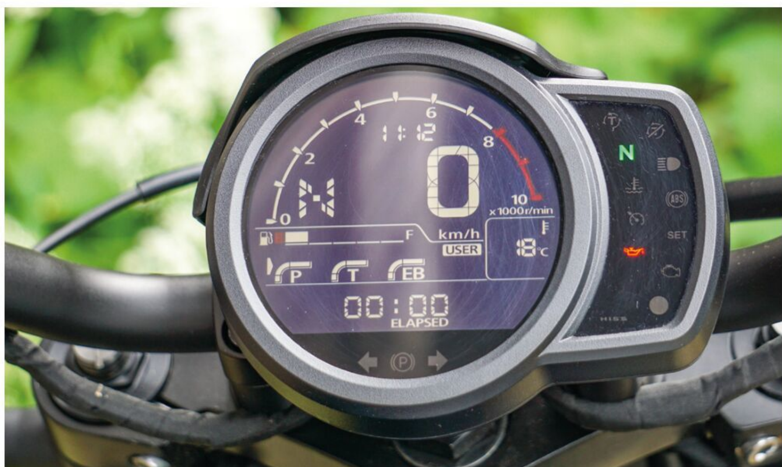
Negativ-Rundinstrument mit Erweiterung für die Warnlampen-Sammlung.
