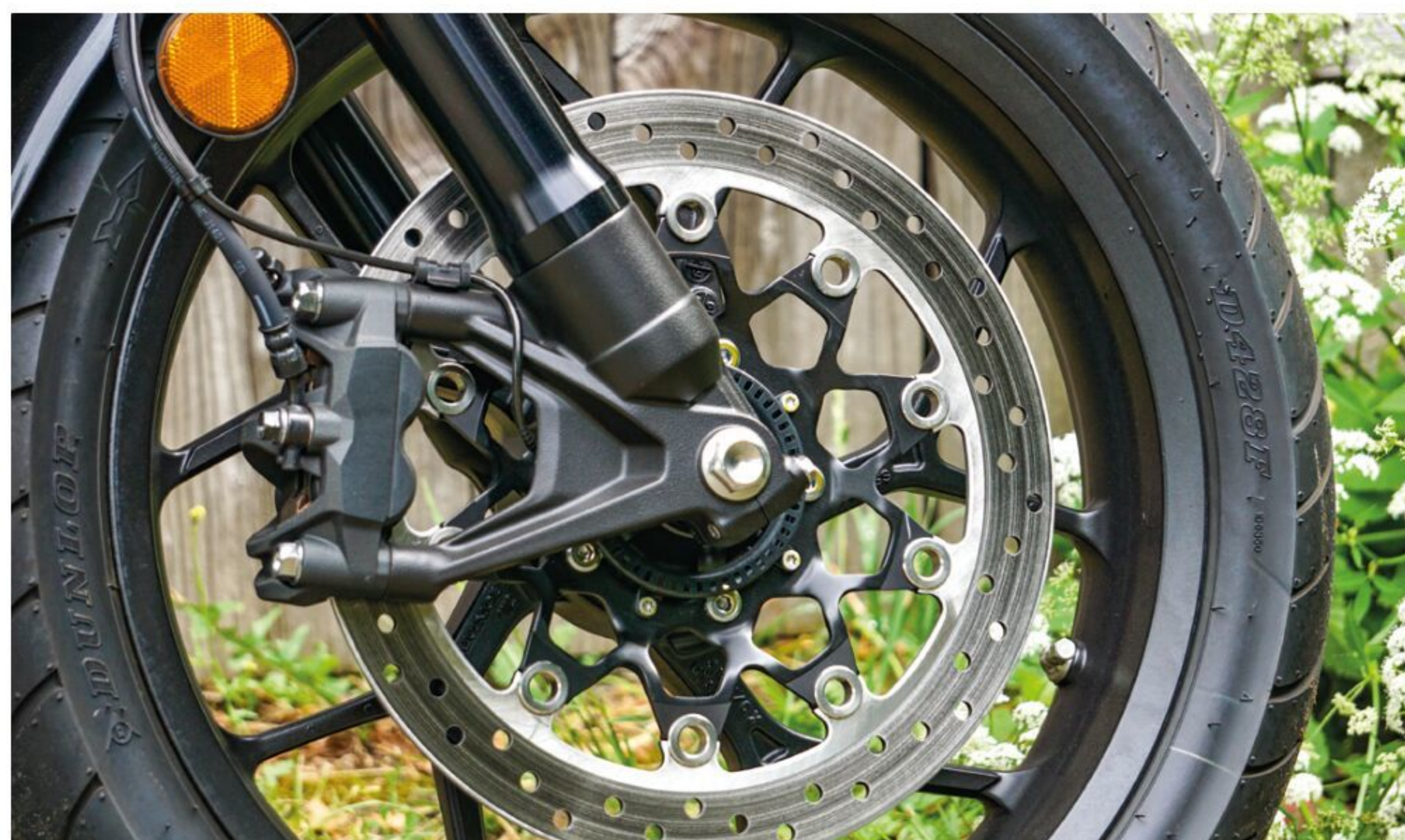
Muss reichen: Einscheiben-Bremsanlage vorn mit 330-mm-Scheibe und radial befestigten Vierkolbenbremszangen.
