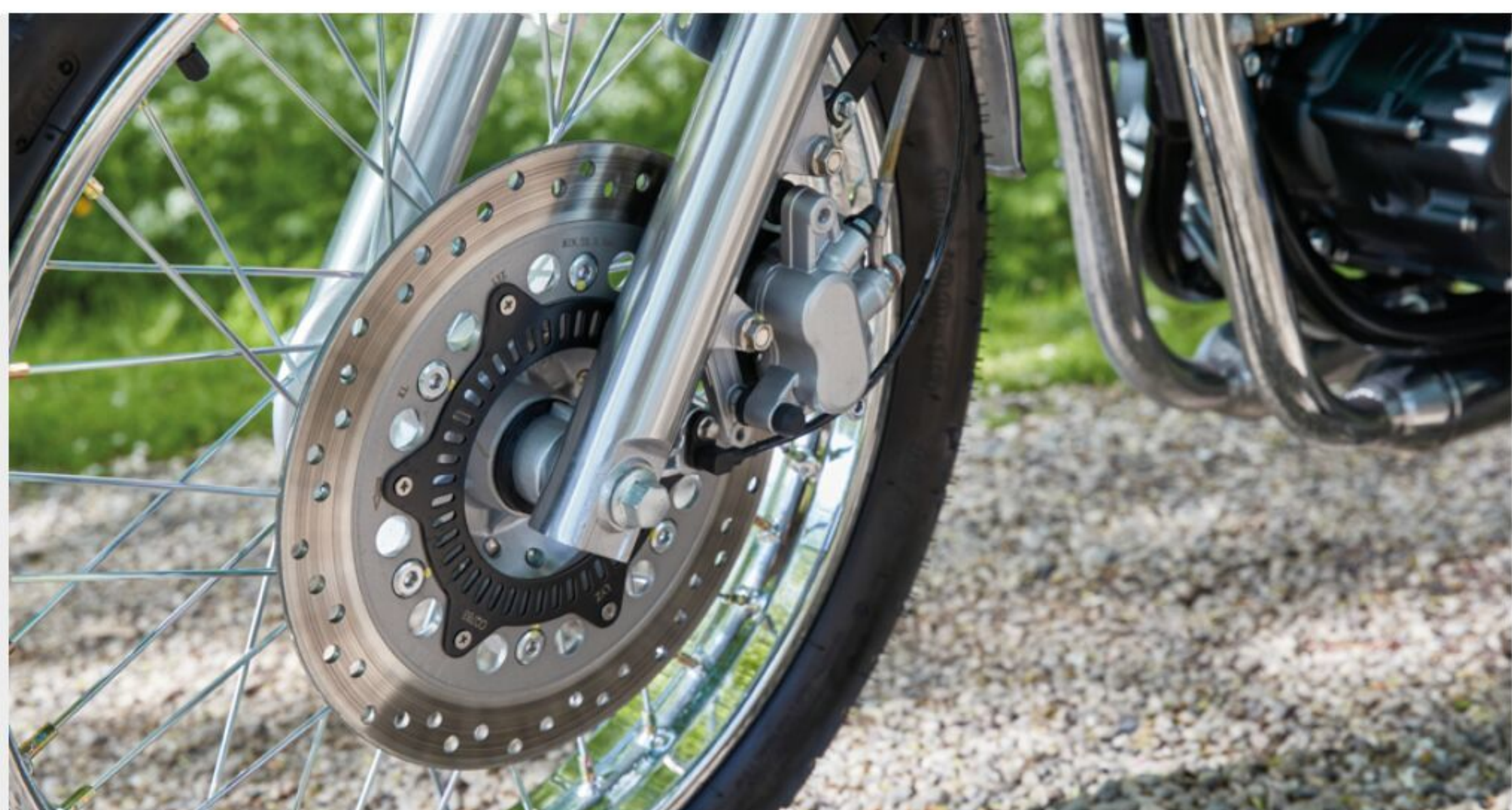
Mit Scheibenbremsen, ABS und Stahlflexbremsleitungen sind die Stopper der Mash Five Hundred auf dem aktuellen Stand der Technik.
