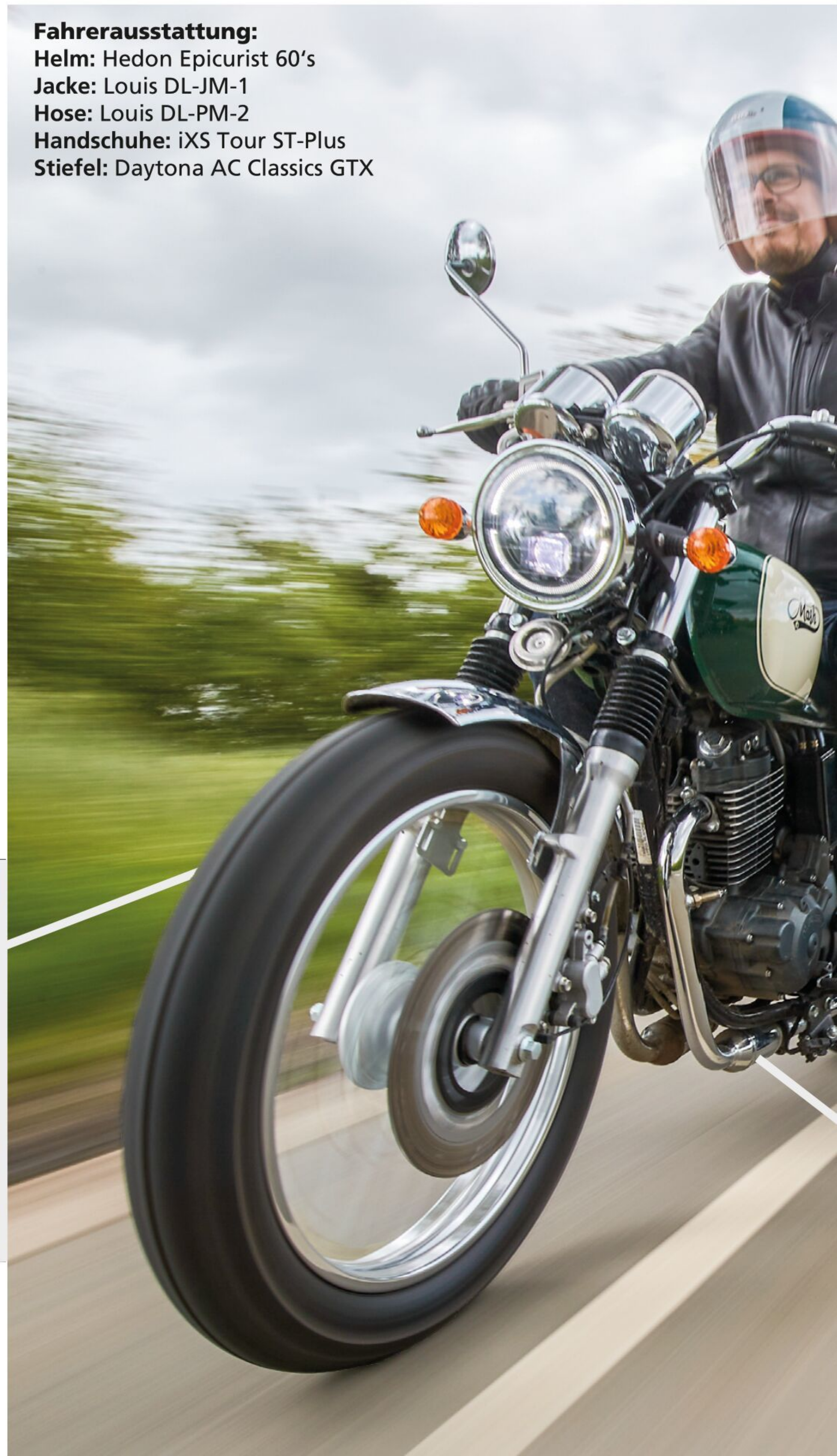
Mit Scheibenbremsen, ABS und Stahlflexbremsleitungen sind die Stopper der Mash Five Hundred auf dem aktuellen Stand der Technik.
