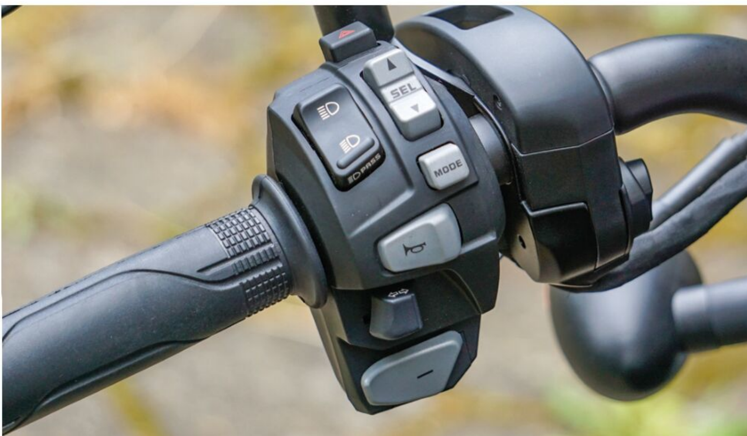
Bedienelemente: links „Mode“-Taste zum Wechseln der Fahrmodi, Feststellbremse rechts neben der Armatur. Rechts: Schaltwippe für Fahrmodus (D), Tempomat serienmäßig
