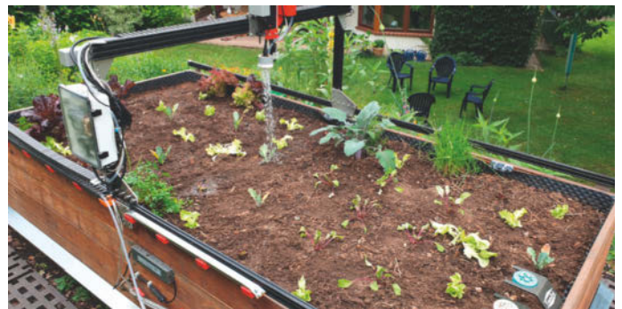
Um bei der Folgebepflanzung die Keimzeit einzusparen, kaufen wir Jungpflanzen beim Gartencenter. Statt zu säen, drückte der FarmBot Löcher an die digital geplanten Standorte.
